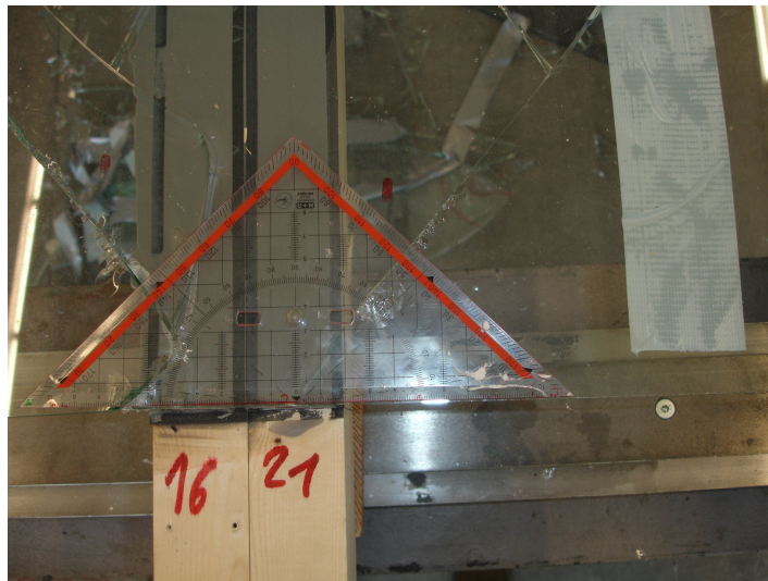
Abbildung 3.26.: Platte III: Schubversagen im Glas mit einem Lastausbreitungswinkel von etwa 37^\circ
