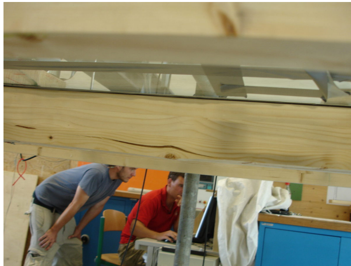
Abbildung 3.28.: Versagen der Platte V
