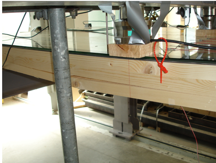
Abbildung 3.21.: Versagen der Platte I
