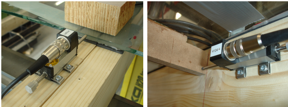
Abbildung 3.14.: Induktive Wegaufnehmer beim Auflager (a) und in den Viertel-Punkten (b)
