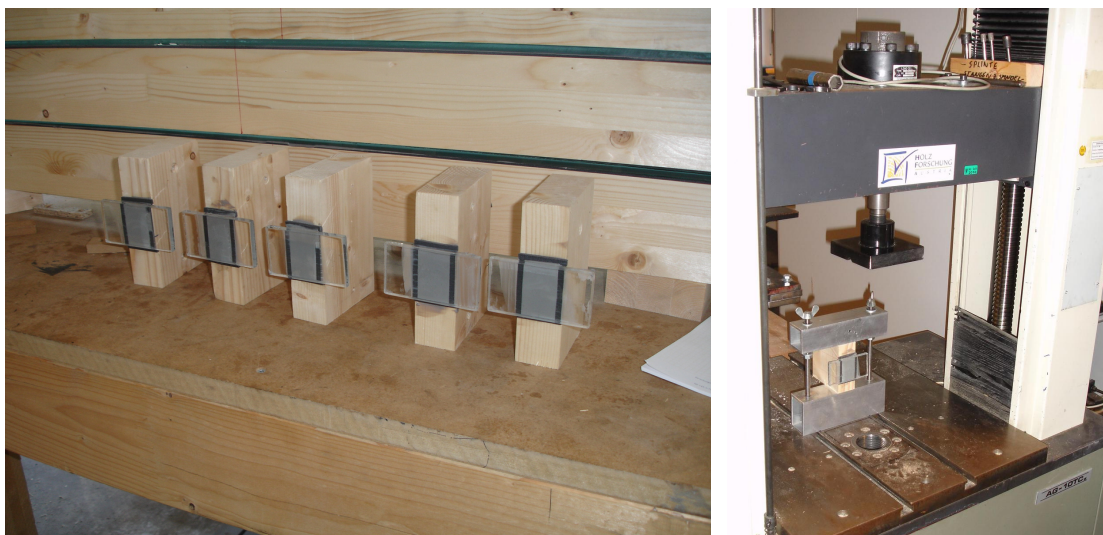
Abbildung 3.2.: Kleinproben - Probekörper (a) und Versuchsanordnung (b)
