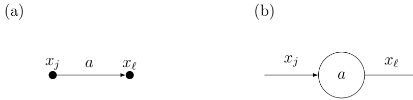
Abbildung 3.3: Visualisierung einer Multiplikation durch einen Signalflussgraphen: (a) klassische Darstellung, (b) alternative Darstellung
