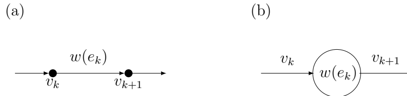
Abbildung 2.1: Visualisierung einer Kante e_k in gerichteten gewichteten Graphen: (a) klassische Darstellung, (b) alternative Darstellung
