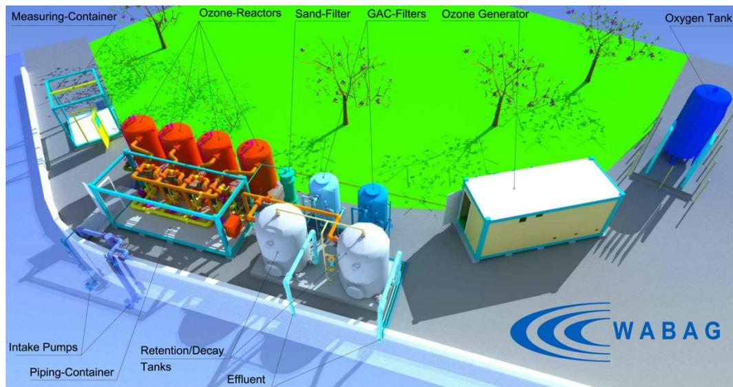
Abbildung 4: Rendering der „KomOzAk“ Versuchsanlage
