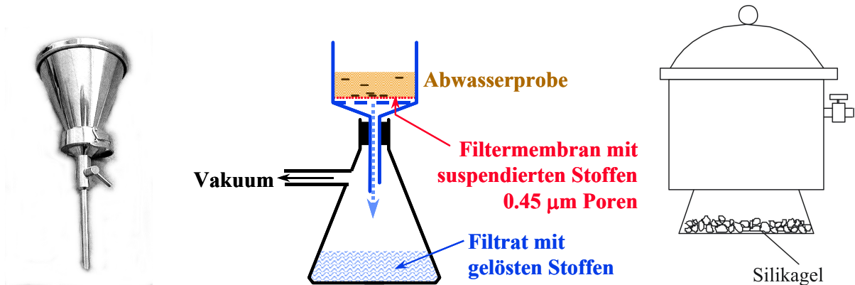
Filtrationseinheit Apparatur für Membranfiltration (Schema)
