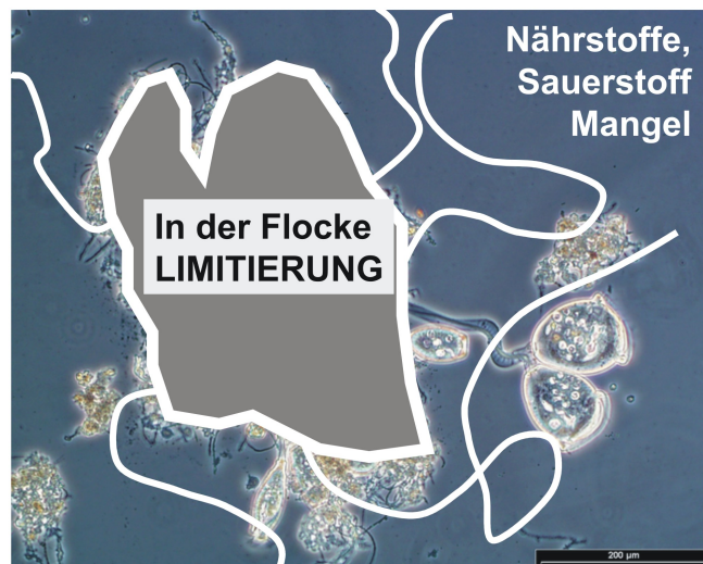
Abbildung 11-43: Substratmangel, nur der äußere Bereich der Flocke ist gut versorgt, Fadenorganismen haben einen Vorteil.
