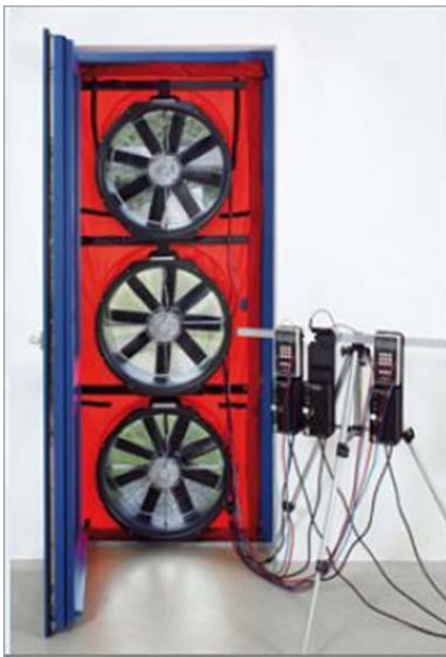
Abb. 1 : Messgerät mit 3 Ventilatoren der Marke Minneapolis Blower-Door im eingebauten Zustand [BLO12]
