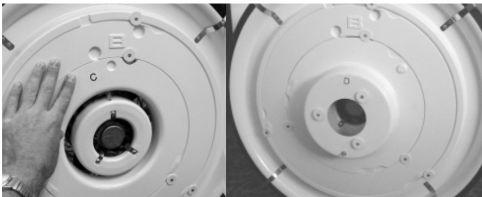
Abb. 19 : Blende C und D des Minneapolis Blower-Door Modell 4 [ENE04]
