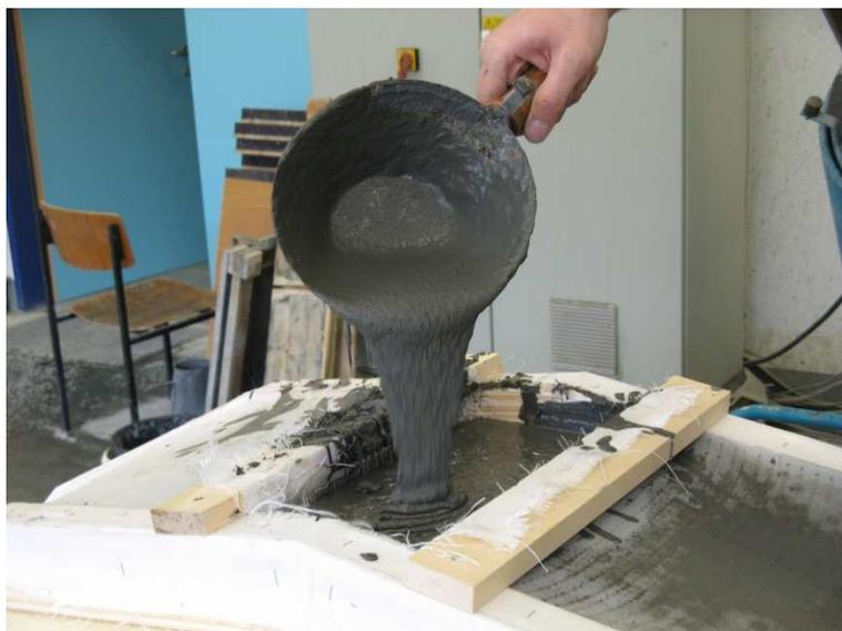
Abbildung 5-8: Manueller Einfüllvorgang
