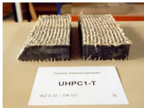
Abbildung 4-17: Bruchbild UHPC1 konventionell (links), textil (rechts)
