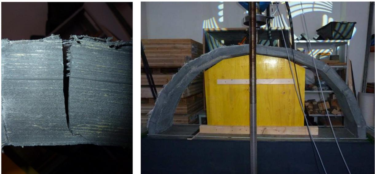
Abbildung 5-17: Bogensegment nach der Belastungsprüfung
