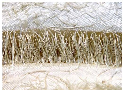
Abbildung 4-1: Textiles Zweiwandgewebe: Decklage und Abstandsfäden
