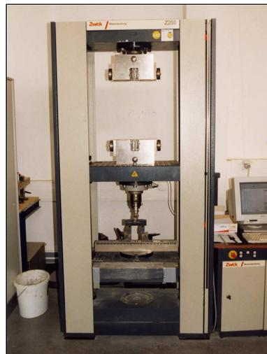
Abbildung 3-11: Prüfmaschine zur Bestimmung der Biegezugfestigkeit
