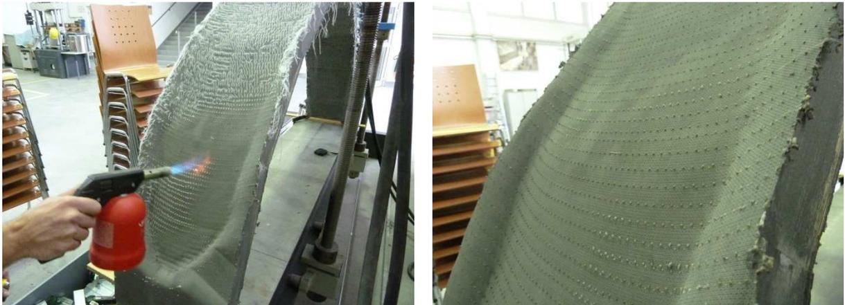
Abbildung 5-13: Entfernen der Abstandsfäden mittels Lötlampe
