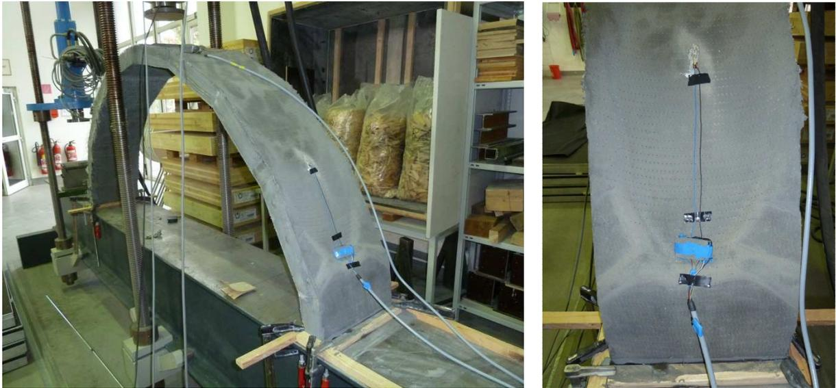
Abbildung 5-16: Dehnmessstreifen
