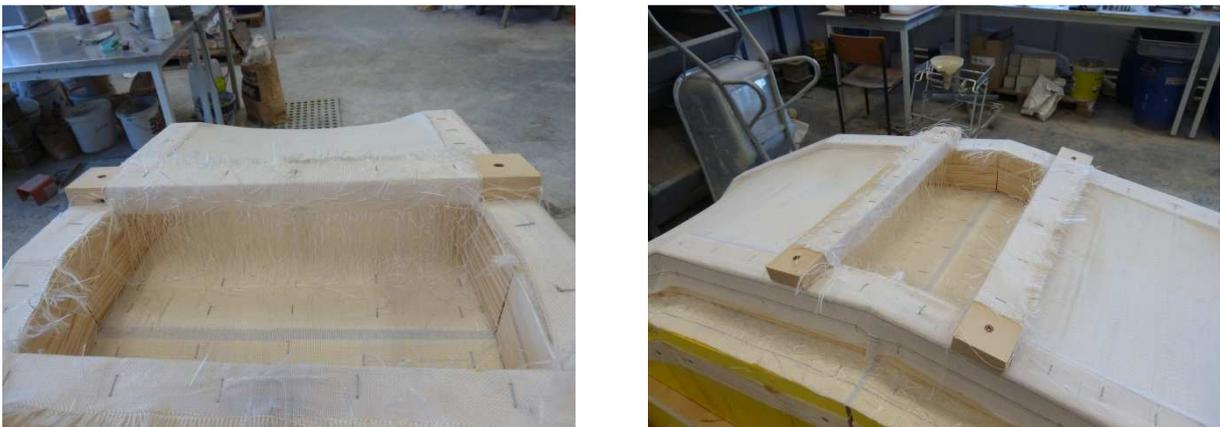
Abbildung 5-3: Einfüllöffnung
