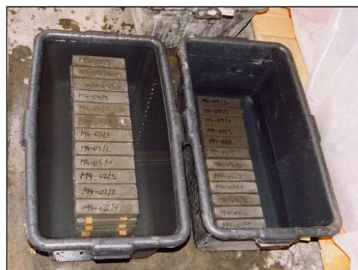
Abbildung 3-10: Lagerung der Probekörper im Wasserbad
