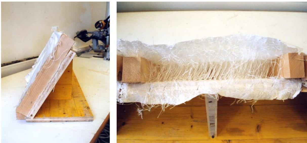
Abbildung 4-6: Detailansicht Textiles Schalungssystem
