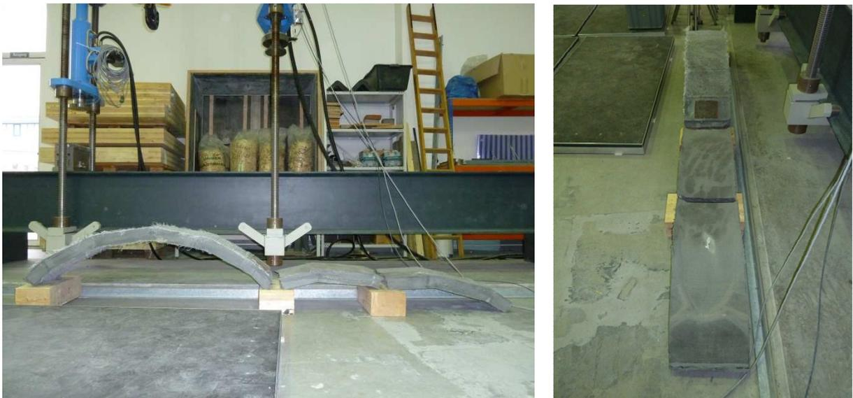
Abbildung 5-20: Bogensegment nach dem Belastungstest
