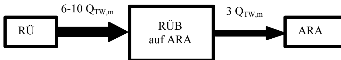
Abbildung 3-1: Grundsätzliche Konzeption der Mischwasserableitung in Großbritannien
