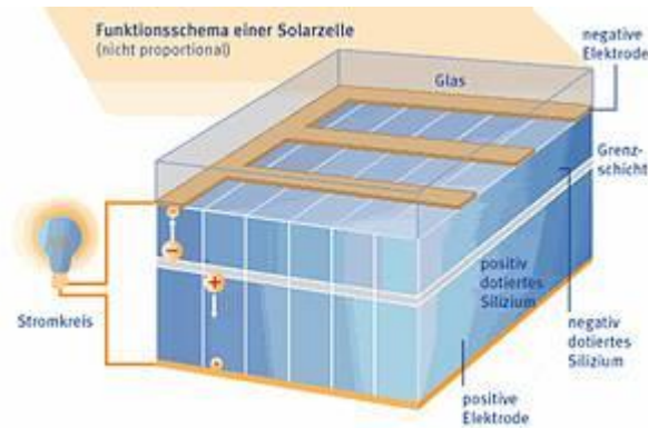
Abb. 2 - Wirkweise einer Solarzellen (Quelle: http://www.voigtundcollegen.de/soles-solarfonds/rendite-aus-der-sonne/solartechnologie/ )
