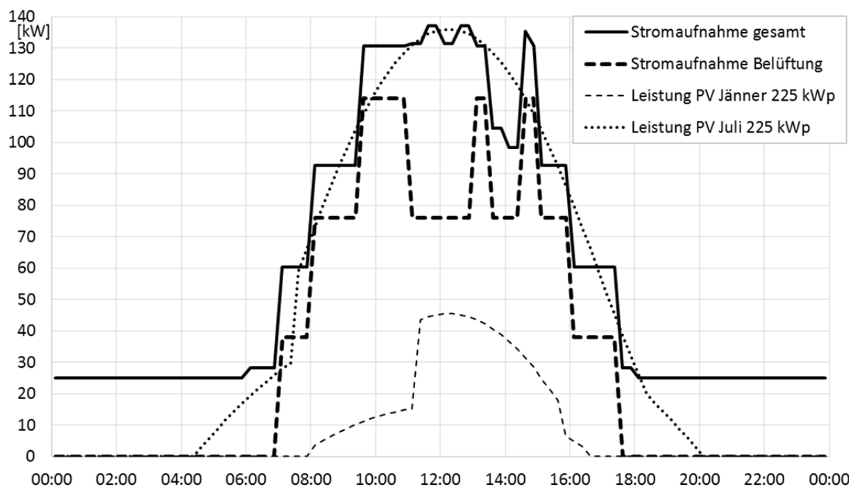
Abbildung 7: Stromverbrauch der Beispielläranlage nach Lastverschiebung – für die Belüftung und gesamt – sowie Leistungskurven einer PV-Anlage mit 225 kWp im Mittel der Monate Jänner bzw. Juli
