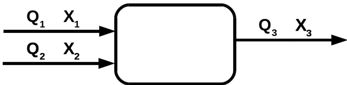
Abbildung 4: Beispielsystem mit 2 Stoffströmen im Zulauf und 1 Stoffstrom im Ablauf.
