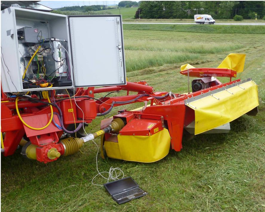
**Abb. 11.3:** Mähwerk mit Industrieelektrokomponenten
