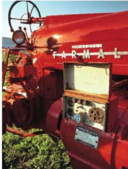
**Abb. 3.5:** IHC Farmall mit seitlich montiertem Electrall Anschlussklemmen oberhalb des Generators [Kla09] S.136
