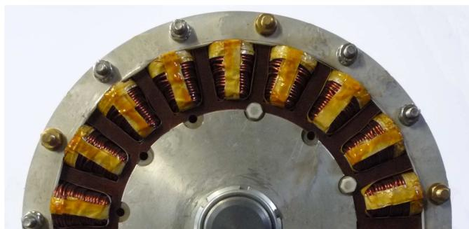
**Abb. 9.5:** Bild von Rotor und Stator im Querschnitt [Dem10]
