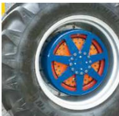
**Abb. 8.5:** Rigitrac Radnabe mit Reifen [Böh11]
