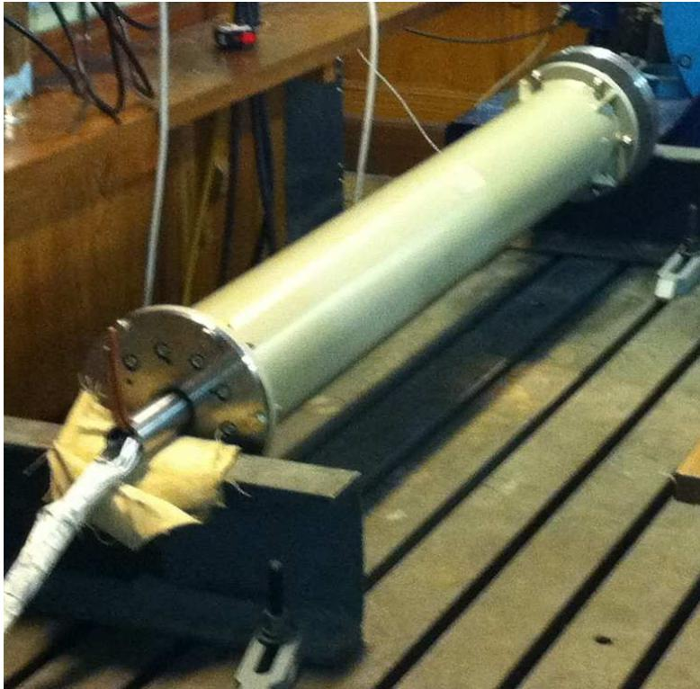
Abb. C.1: Rohrmotor am Prüfstand
