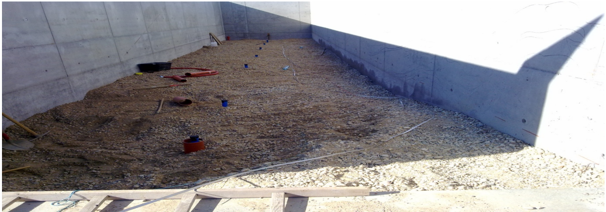
Abbildung 3.30 Blick in die Versuchseinrichtung: im Grundwasserleiter eingebaute Standrohrpegel
