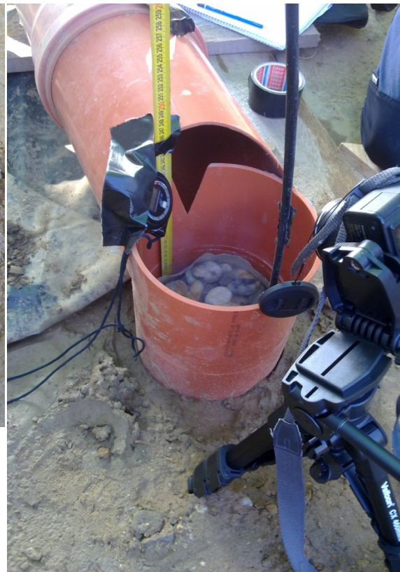
Abbildung 3.30 Blick in die Versuchseinrichtung: im Grundwasserleiter eingebaute Standrohrpegel
