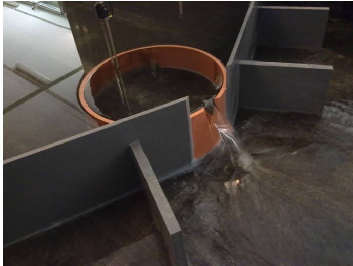
Abbildung 3.23 oben: Kalibrierung des Messwehres in einem Wasserfangsrohr mit 400 mm Durchmesser bei einem Durchfluss von 0,8 l/s
