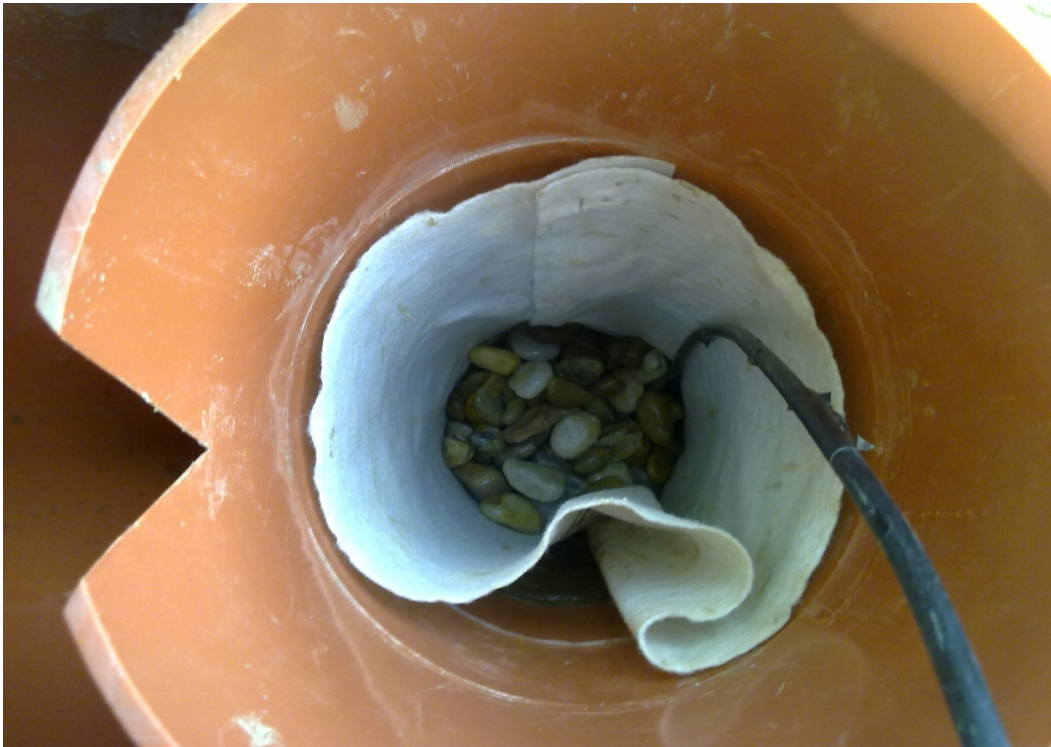
Abbildung 3.10 Blick von oben in die Kiessäule: Drainagematerial umhüllt mit einem Filtervlies, Kabelleitung des eingebauten Messpegels sowie Messwehr;
