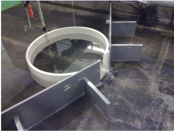
Abbildung 3.26 Kalibrierung des Messwehres in einem Wasserfassungsrohr mit 600 mm Durchmesser bei einem Durchfluss von 0,8 l/s
