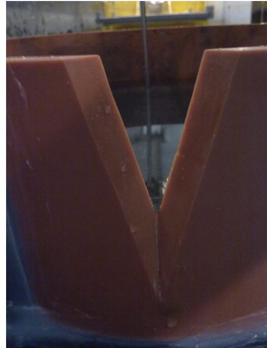
Abbildung 3.23 oben: Kalibrierung des Messwehres in einem Wasserfangsrohr mit 400 mm Durchmesser bei einem Durchfluss von 0,8 l/s
