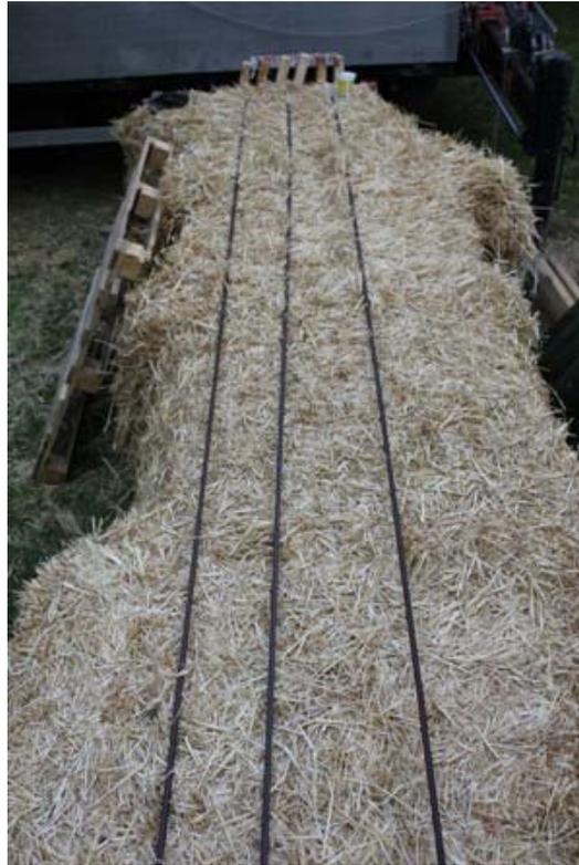
Abb. 6-3: „Winkelverzerrung und Ausknicken des Trägers aus Strohballen“
