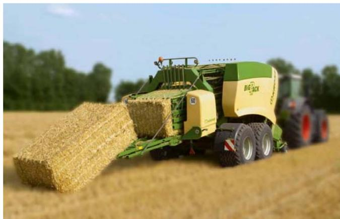
Abb. 2-36: „BiG Pack HDP II - High Density Großpackenpresse“ (Maschinenfabrik Bernard KRONE GmbH (2013); „BiG Pack HDP II - High Density Großpackenpresse“ 10/13, Titelbild)
