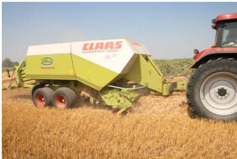
Abb. 5.3-1: „Die Ballenpresse beim Herstellen der Quaderballen“;
