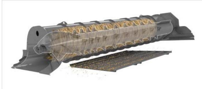
Abb. 2-31: „Darstellung eines axialen Dreschwerks“
