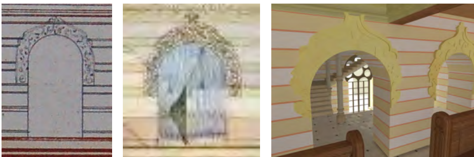
Abb. 96-98: Planmaterial – Rendering Bogenförmigen Durchbruch
