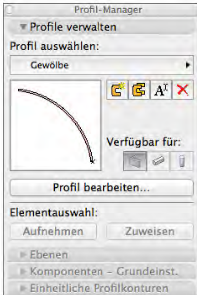
Abb. 151 - 152: Profil Gewölbe; Dieses Profil wurde hergestellt zur Rekonstruktion des rechteckigen Gewölbes; durch die Profileigenschaften verliefen die Eckausbildungen sauber ohne der Anwendung von Booleschen Operationen
