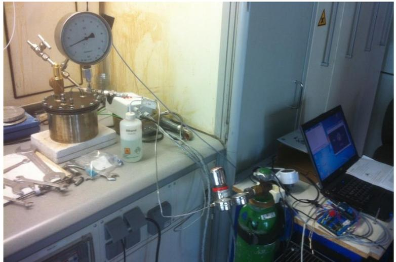
Abbildung 10: Kalibrierung Drucksensor
