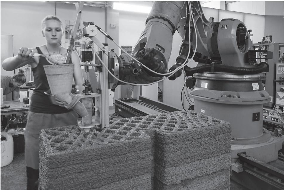
Abb. 7: Additive Fertigung eines multifunktionalen Wandelementes durch Extrusion von Holzleichtbeton
