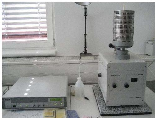
**Abbildung 3.3.** STA 409 EP der Fa. Netzsch
