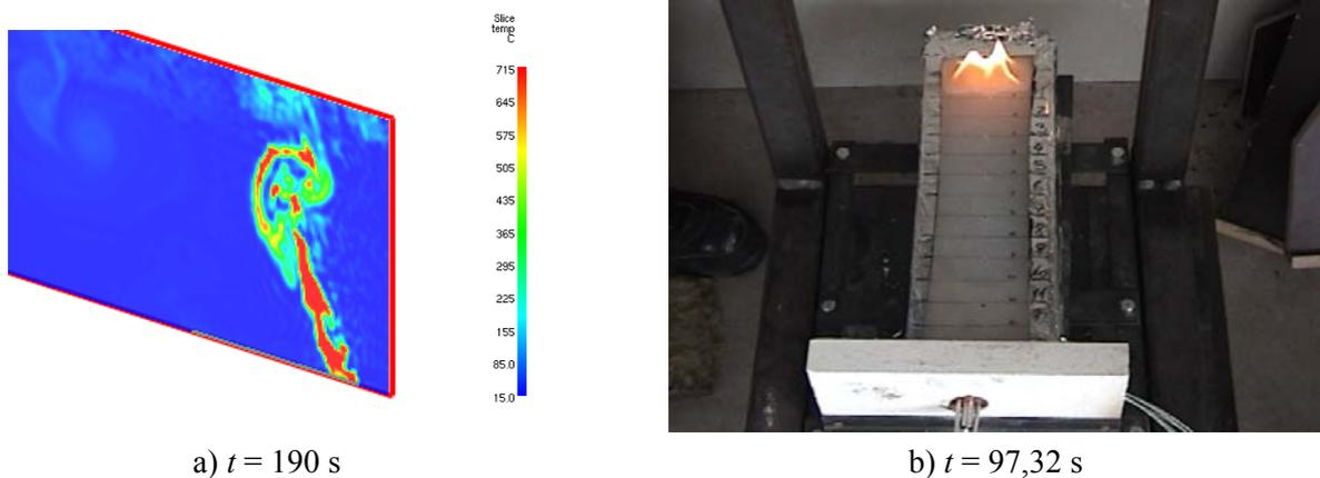
**Abbildung 9.11.** Brandentwicklung kurz nach der erfolgreichen Entzündung bei 0° Neigung der Probe; a) in der FDS-Simulation (Sim: 2D, DNS, 0°) und b) bei den Brandausbreitungsversuchen
