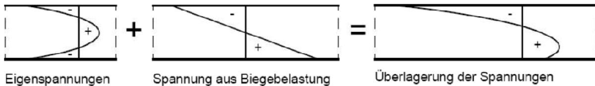
Abbildung 9: Spannungen über die Dicke in thermisch vorgespanntem Glas infolge Biegung (Ofner, 2006)
