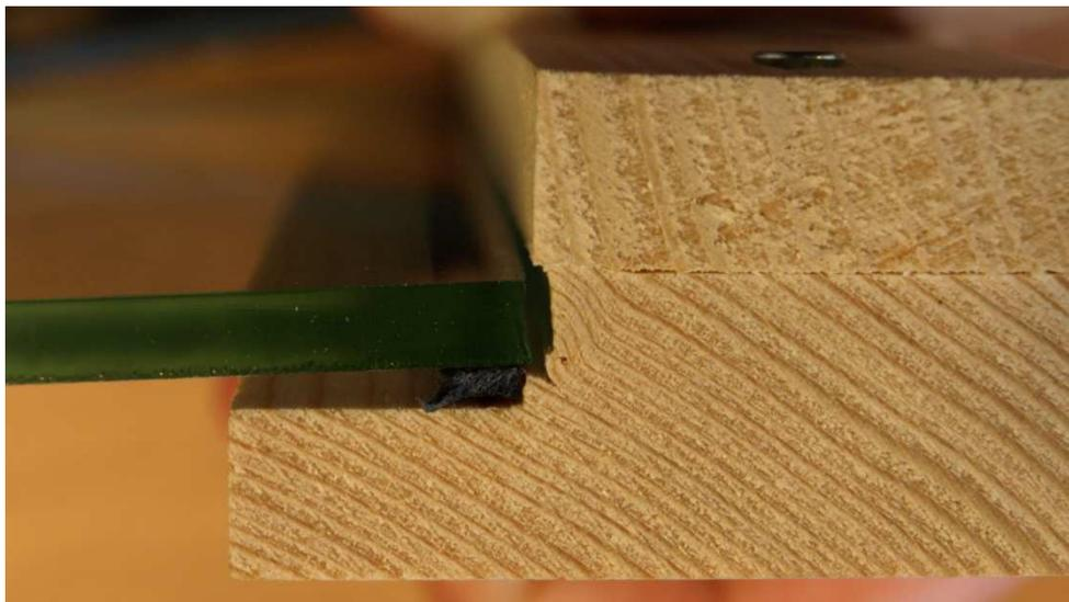
Abbildung 36: Beispiel eines Einpressens der Glasscheibe in das Holz anhand eines Kleinprobekörpers (Hochhauser, 2011) aus Floatglas und Fichtenvollholz infolge Direktkontakt (Foto: ITI)
