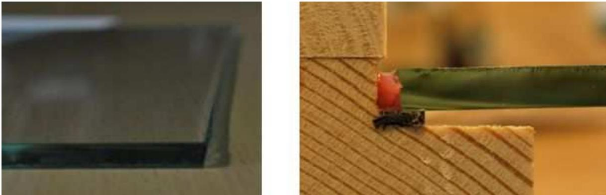
Abbildung 35: Links: Gebrochene Kante einer Floatglasscheibe; Rechts: Kompensation der Kantenunregelmäßigkeiten durch härtende Klötze anhand eines Kleinprobekörpers (Fotos: ITI; Hochhauser, 2011)
