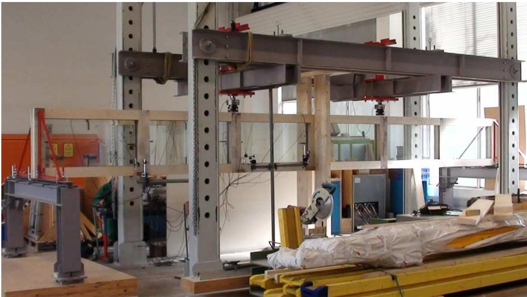
Abbildung 101: Holz-Glas-Verbundträger im Prüfstand (Hochhauser, 2011)
