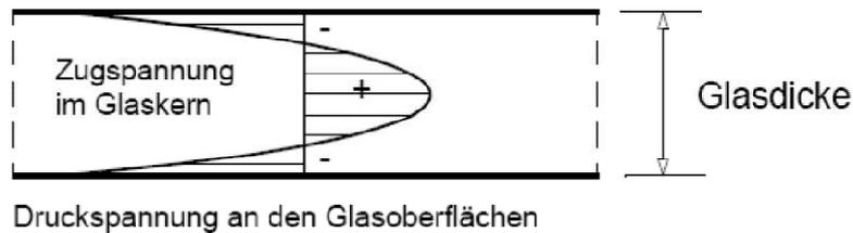
Abbildung 8: Eigenspannungen in thermisch vorgespannten Gläsern (Ofner, 2006)
