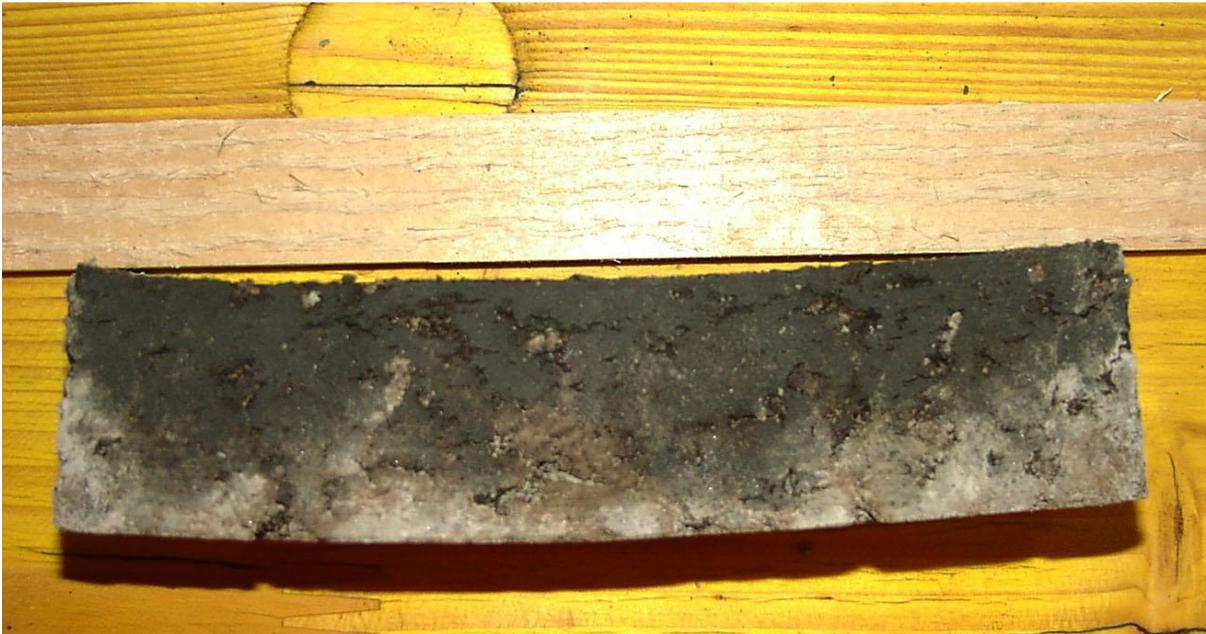
**Abbildung 5-5** Probekörper mit 20% Natronwasserglas
