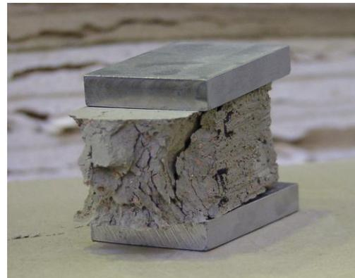
Abbildung 4-7 Aufbau des Druckversuches
