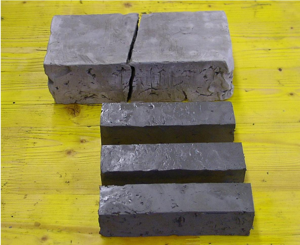
**Abbildung 4-4** Vergleich Lehmstein in Mauerziegelformat zu Lehmprisma
