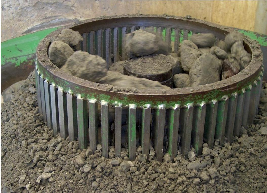
**Abbildung 2-2** Rundsieb von der Firma Wienerberger
