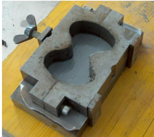
Nachdem die 5 Kugeln entsprechend der Normsteife hergestellt waren, wurden sofort 5 „Achterling“ produziert. Die Herstellung ging sehr gut und rasch, so dass zwischenzeitlich keine Austrocknung des Lehmes stattfand.
