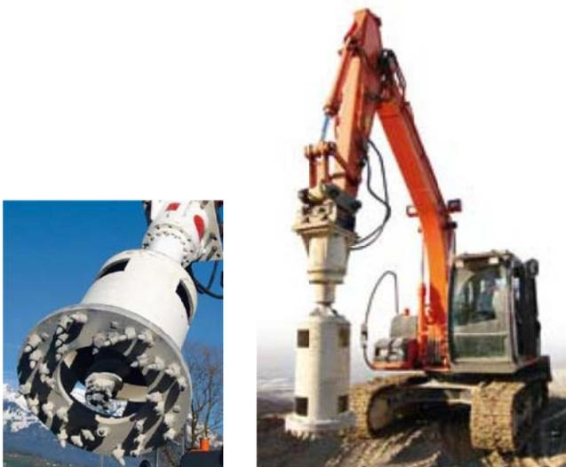
Abb. 37: Pfahlkopf-Fräse<sup>56</sup>
