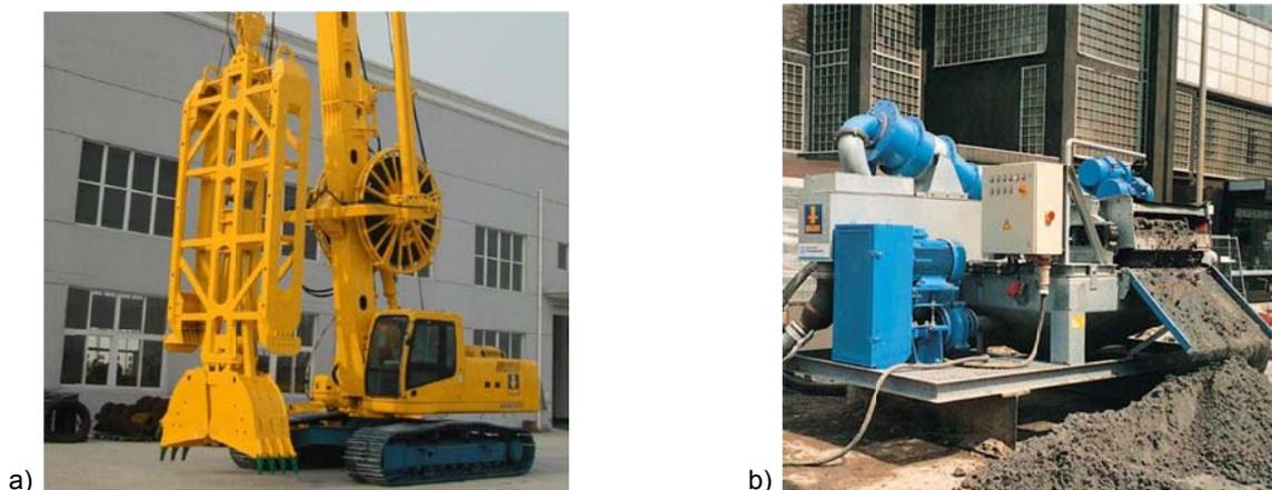
Abb. 58: Geräte für die Herstellung der Schlitzwand – a) Hydraulik-Seilbagger mit Greifer; b) Bentonitanlage
