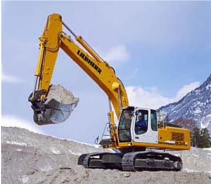
Abb. 38: Hydraulikbagger auf Raupen<sup>57</sup>
