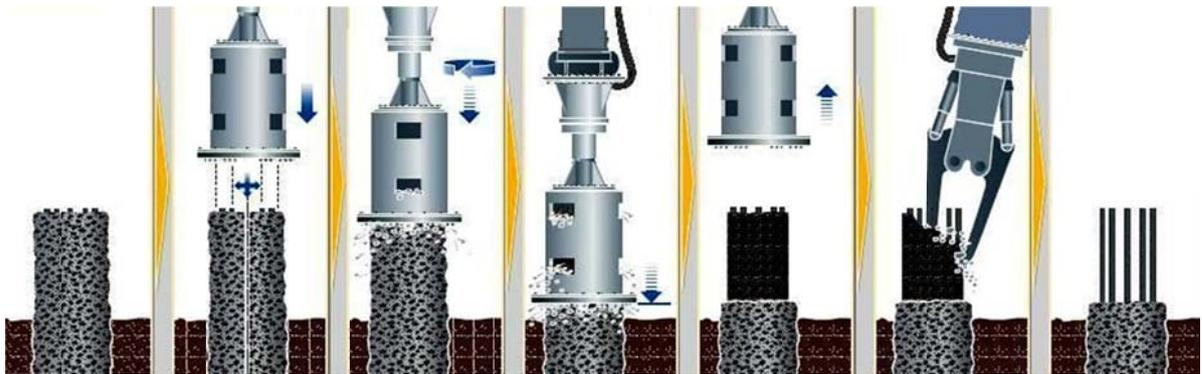
Abb. 32: Arbeitsweise beim Abfräsen mit Pfahlkopffräse<sup>52</sup>
