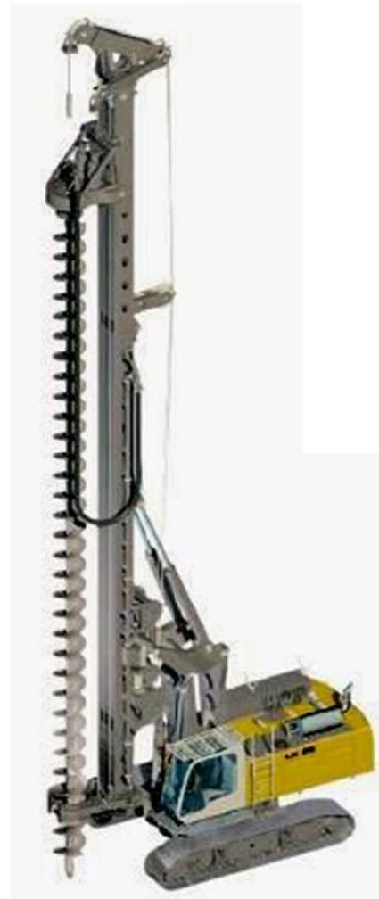
Abb. 27: Unverrohrte Hydraulikverfahren mit Langschnecke<sup>36</sup>
