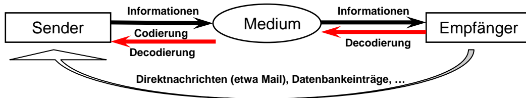
Abbildung 1-7: Empfänger korrespondiert mit Sender – aktives Medium
