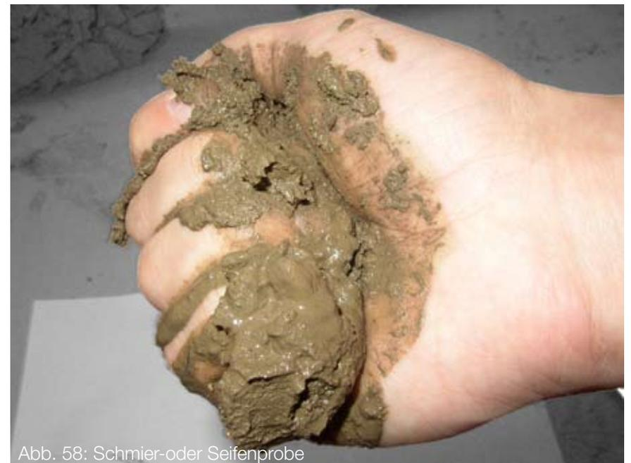
Abb. 58: Schmier-oder Seifenprobe
