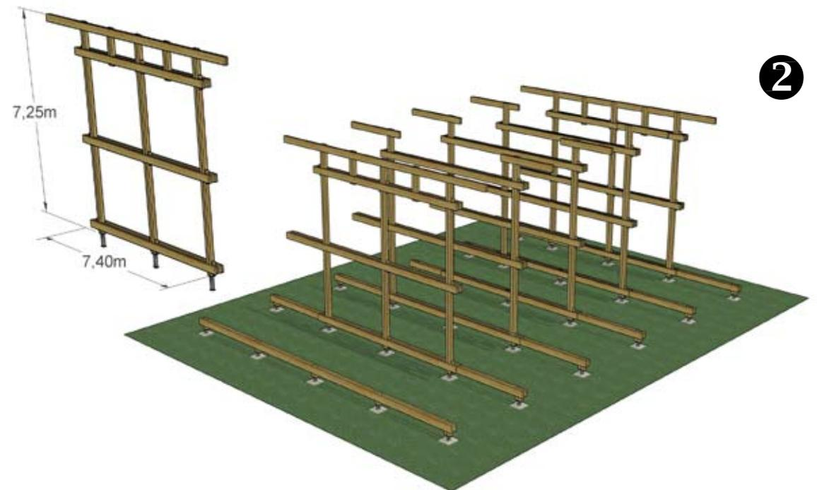
2. Die Holzrahmen werden in die Fundamente eingesetzt und der Stahlfuß mit Vergussbeton einbetoniert.
