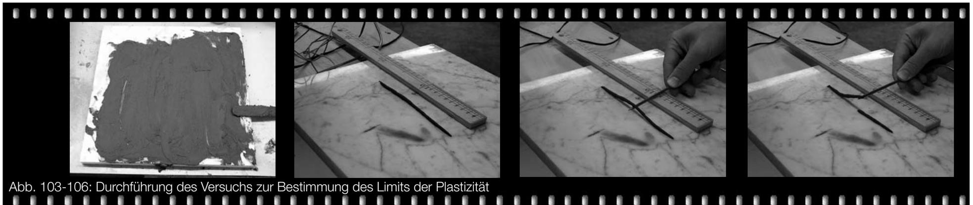
Abb. 103-106: Durchführung des Versuchs zur Bestimmung des Limits der Plastizität
