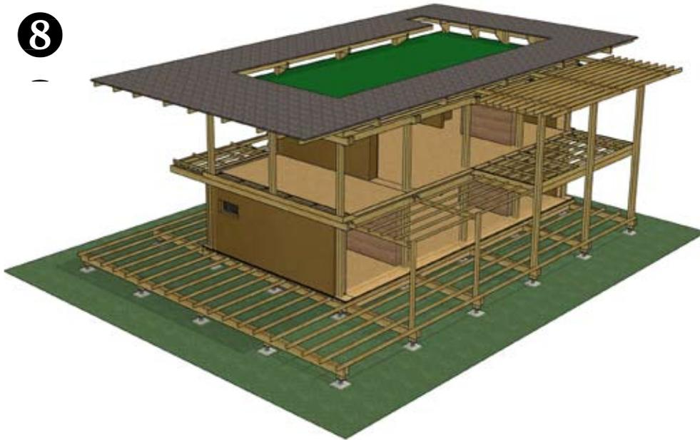
8. Das Dach wird errichtet. Sodann können die Wände mit Leichtleh ausgefacht werden.
