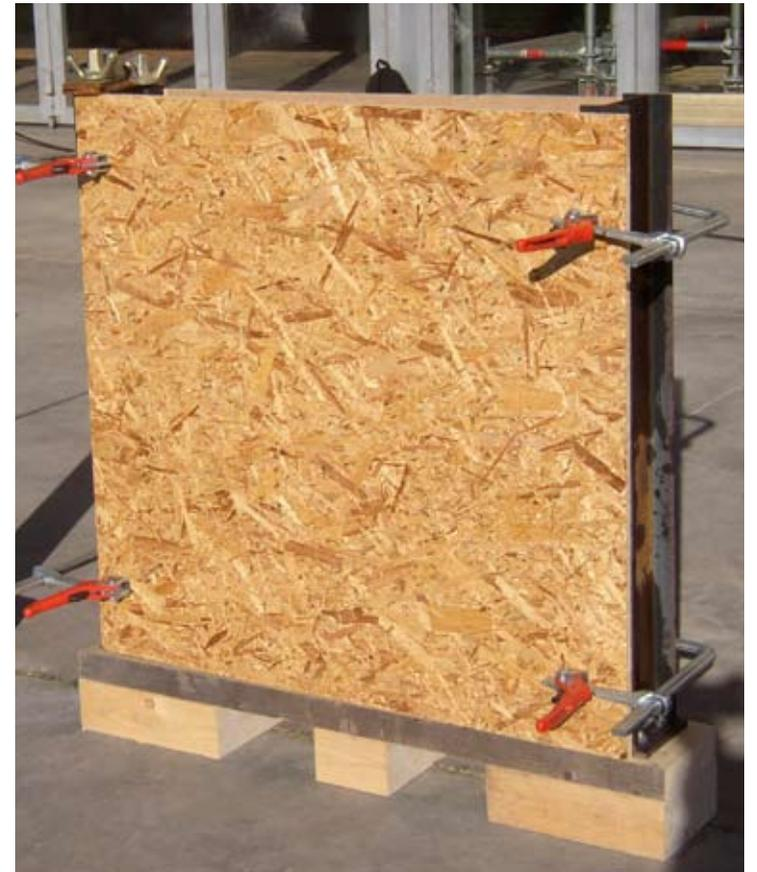
Abb. 115: Schalung für die Versuchswände
