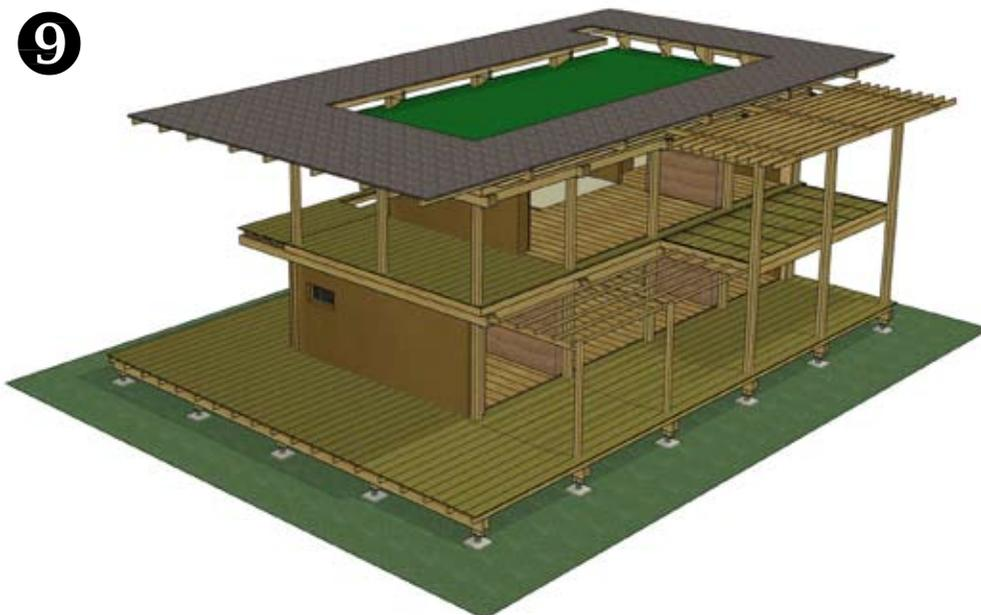
9. Die Böden werden verlegt und die Fenster eingesetzt. Darauf kann mit dem Innenausbau begonnen werden.
