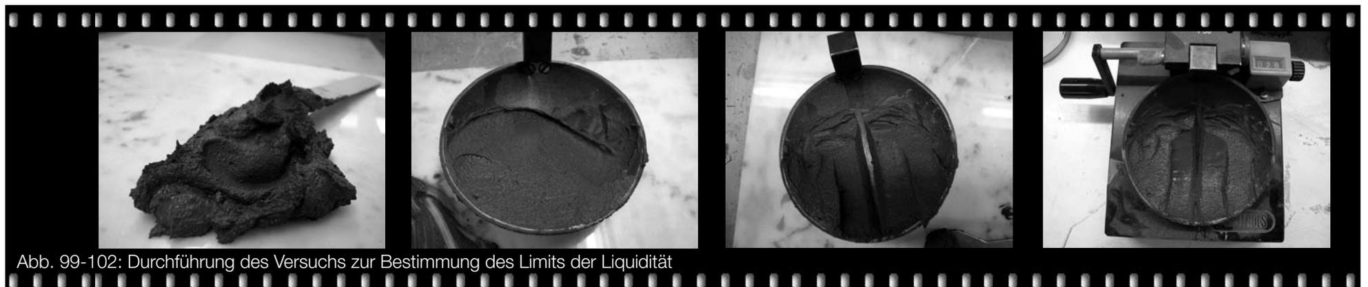
Abb. 99-102: Durchführung des Versuchs zur Bestimmung des Limits der Liquidität
