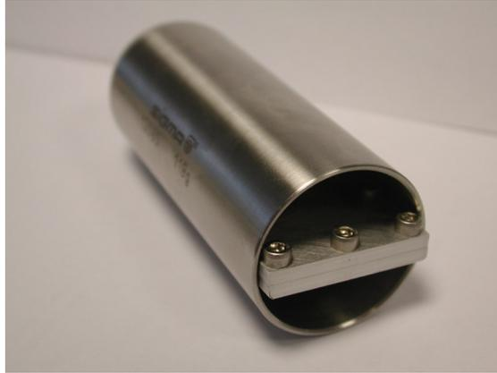
Abbildung 10.2: Testkassette in Zentrifugenbecher.
