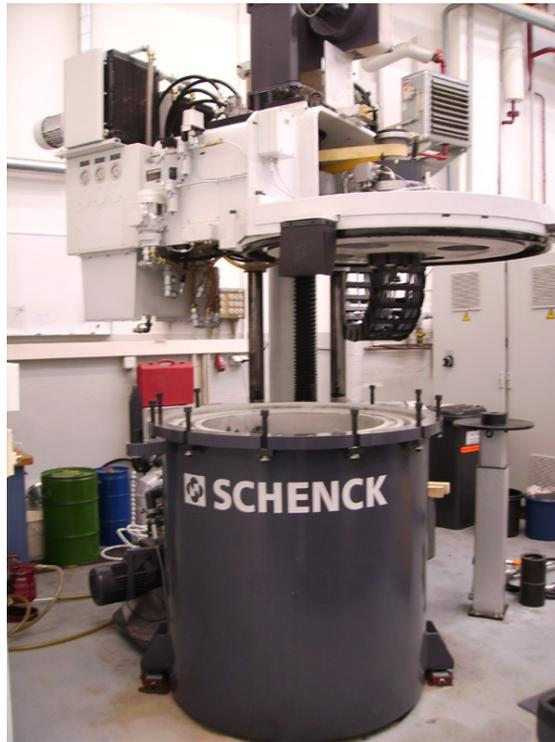
Abbildung 6.1: Der Schleuderstand BI 3 U im geöffneten Zustand.
