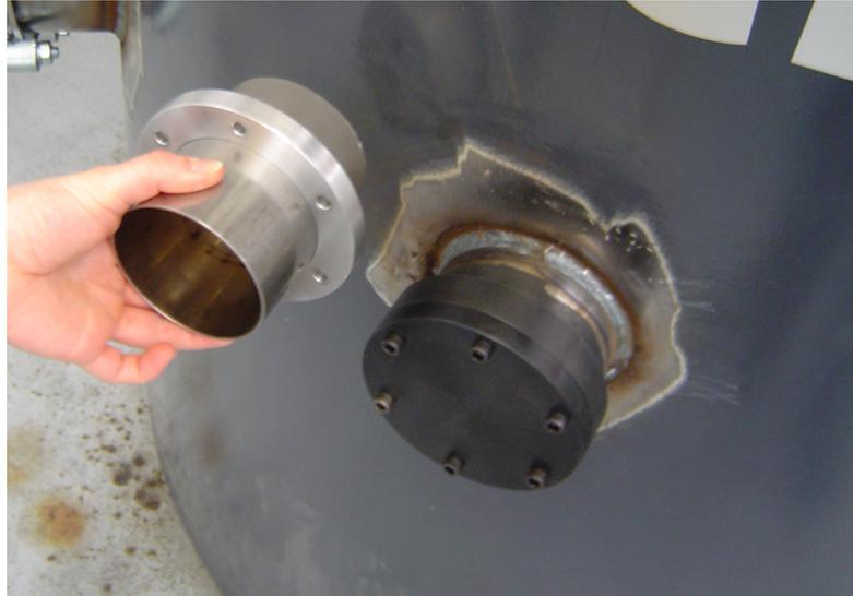
Abbildung 9.22: Angeschweißter Wilson-Flansch mit Blindflansch. Links daneben UCN-Leiter mit Wilson-Dichtung.
