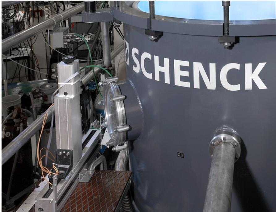
Abbildung 12.18: yz-Linear Schlitten am Ausgangsfenster des PST.
