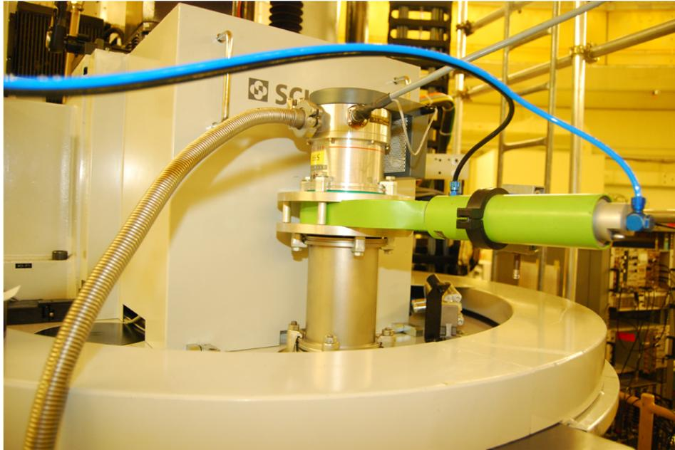
Abbildung 11.5: Turbopumpe und Schiebeventil (grün) am Deckel des Schleuderstands.
