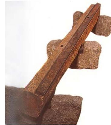
Abb. 21 Schienenstück; ein Schwachpunkt waren die auf die Gleisbäume genagelten Flachschiene, die sich nach Belastung leicht lösten.
