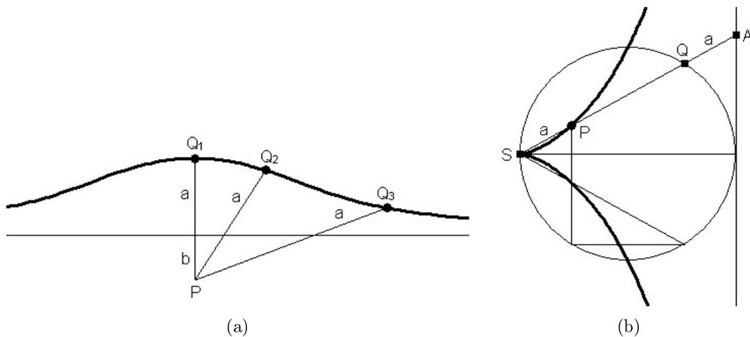
Abbildung 1.7: Spezielle Kurven: (a) Die Konchoide; (b) Die Zissiode
