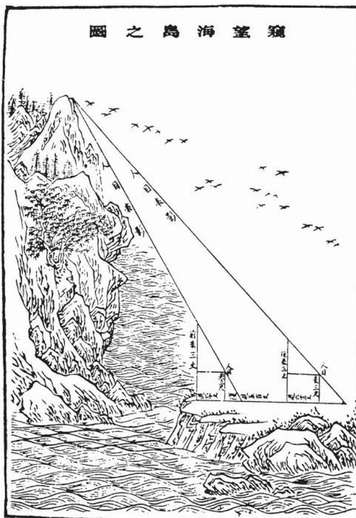
**Abbildung 3.8:** Zur Methode der doppelten Messungen. Blockdruck aus der Enzyklopädie *Tu Shu Ji Chen* (1726) (aus [WUSSING 2008, S. 61])
