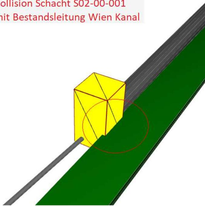
Abbildung 3.36: Kollision Straßenentwässerung - Bestandsleitungen
