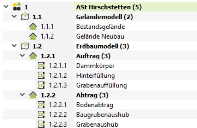
Abbildung 3.6: Ausschnitt der Bauwerkstruktur für den IFC-Export
