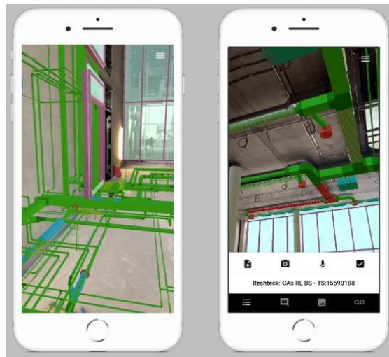
Abbildung 3. Beispiel eines AR-Tablet-Systems zur Qualitätssicherung<sup>29</sup>
