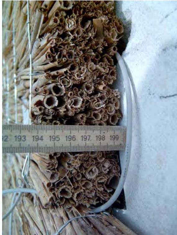
Abb. 32: Querschnitt einer Schilfdämmplatte
