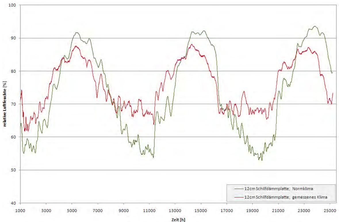
Abb. 59: Vergleich der relativen Luftfeuchten an der kalten Seite einer 12 cm dicken Schilfdämmung in der Ecke bei gemessenem Raumklima und Normklima von 12.7.2007 bis 16.4.2010
