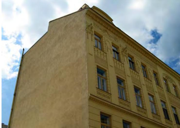
Abb. 13: Gründerzeithaus in Wien Währing; hier könnte straßenseitig eine Innendämmung und an der seitlichen Wand eine Außendämmung angebracht werden.
