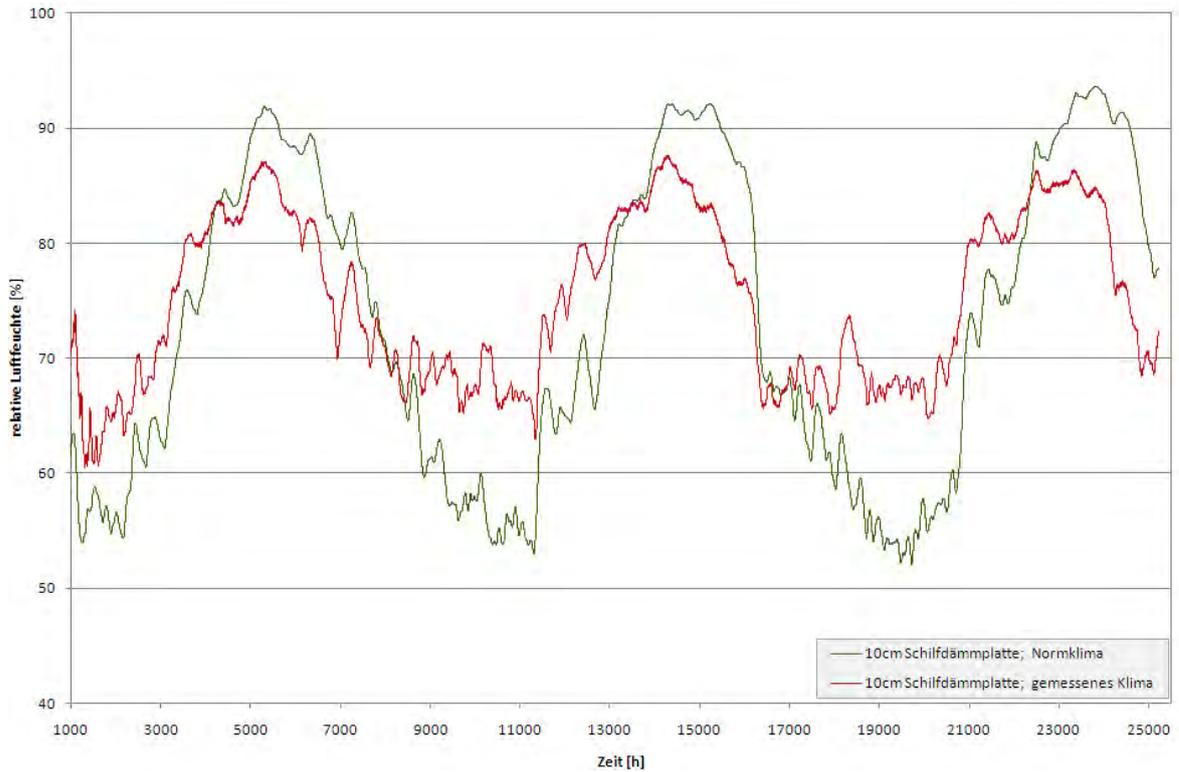
Abb. 58: Vergleich der relativen Luftfeuchten an der kalten Seite einer 10 cm dicken Schilfdämmung in der Ecke bei gemessenem Raumklima und Normklima von 12.7.2007 bis 16.4.2010
