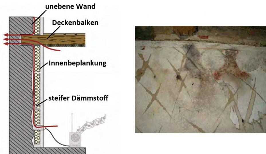
Abb. 5: Durchströmungspfade bei undichter Innendämmung mit Hohlräumen hinter der Dämmebene (links); Schimmelbildung infolge von Durchströmung an undichtem Balkenanschluss (rechts) [BOR06a]
