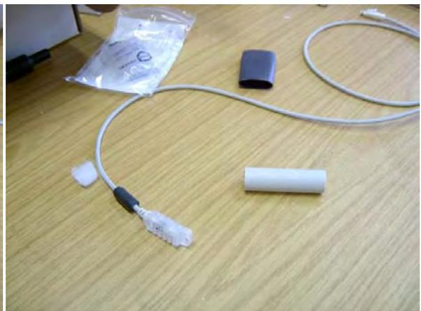
Abb. 26: Sensor mit Hüllrohr und Schrumpfschlauch
