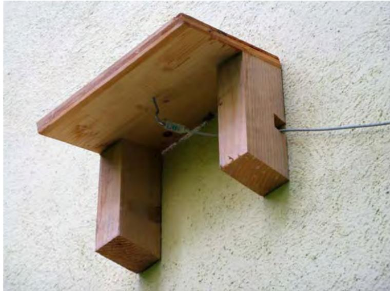
Abb. 29: Außensensor CH4 an der Fassade mit Witterungs- und Direktstrahlungsschutz
