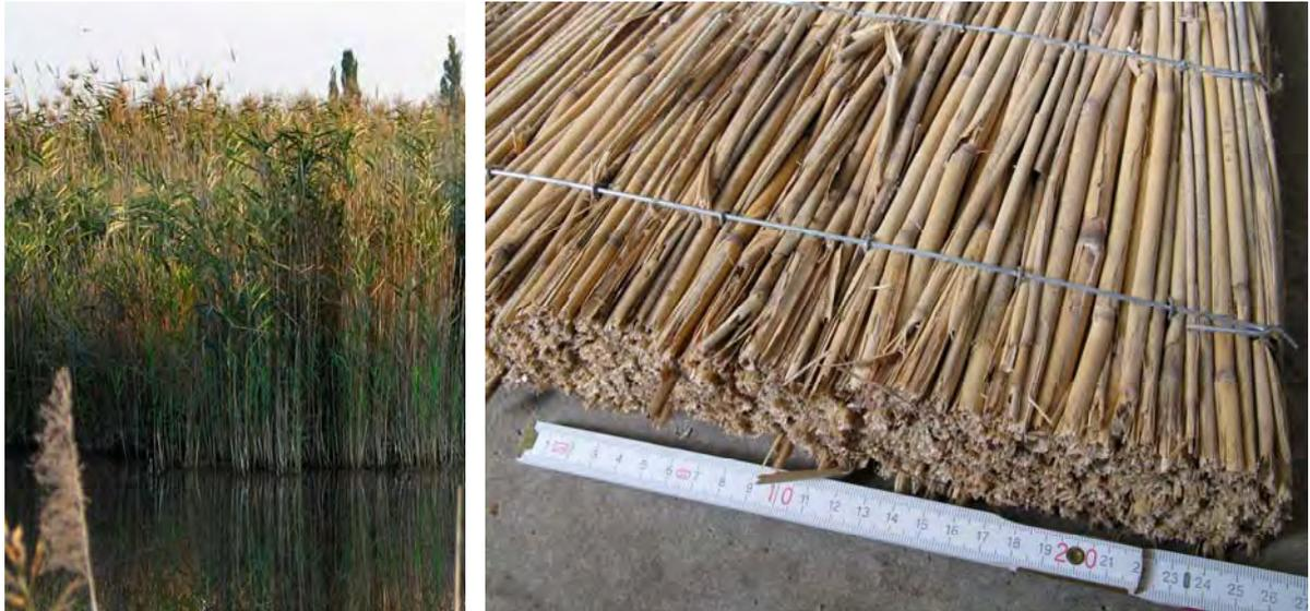
Abb. 23: Schilf und Schilfdämmplatte
