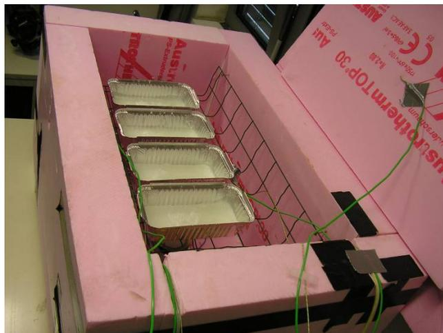
Abbildung 4-2 Einsatz von Paraffin in Messbox
