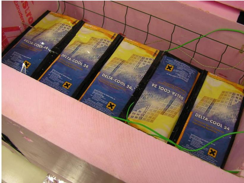
Abbildung 4-13 Einsatz von PCM-Elemente auf Maschendrahtkorb
