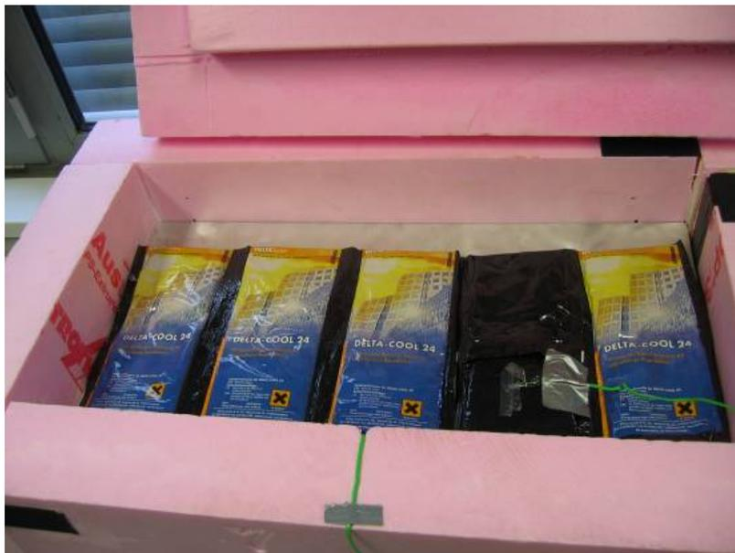
**Abbildung 4-20 Einsatz von PCM-Elemente auf Aluminiumplatte**
