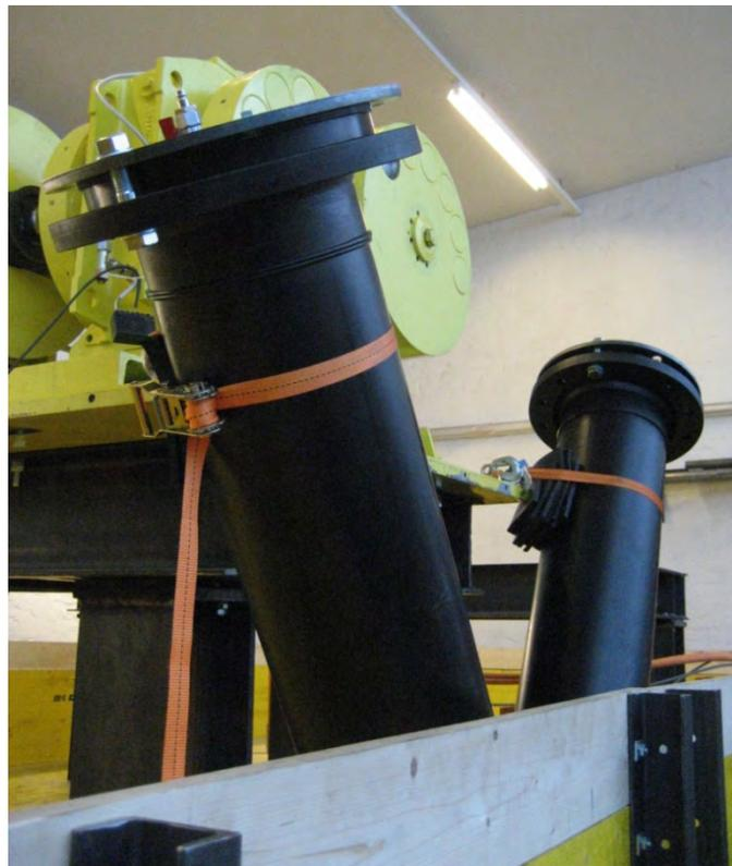
Abbildung 6.1: auf der Versuchsbrücke montierte Flüssigkeitsschwingungstilger
