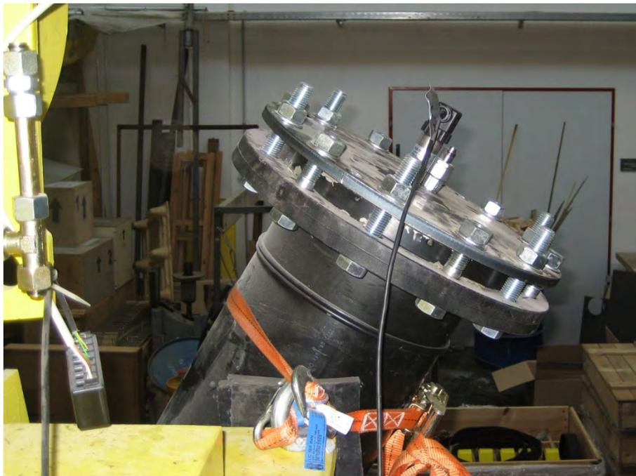
Abbildung 3.76: Drucksensor am Flüssigkeitsschwingungstilger (Versuchsreihe 1) montiert
