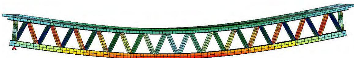
Abbildung 7.8: 1. Eigenform (Biegeeigenform mit 2,27 Hz)
