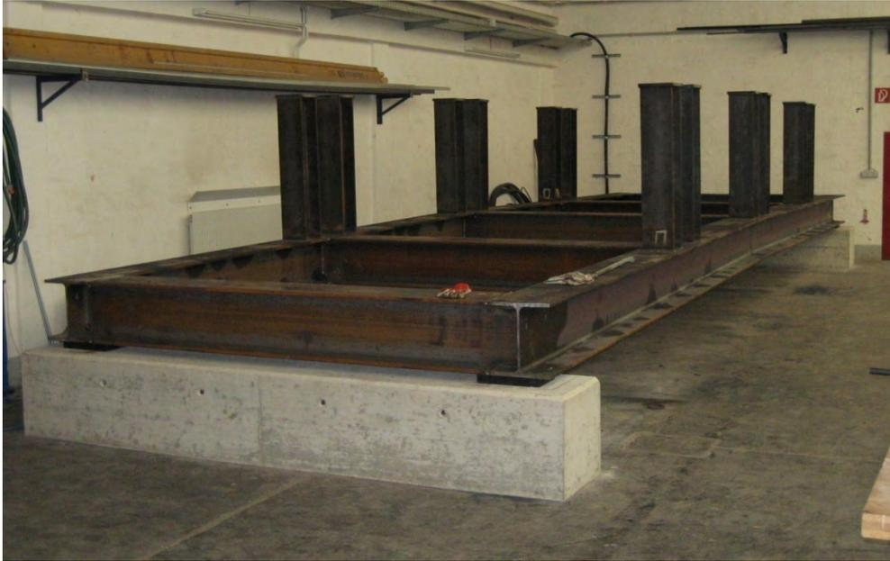
Abbildung 3.7: Trägerrost bestehend aus HEA340, S355J2+N sowie Auflagerbänke
