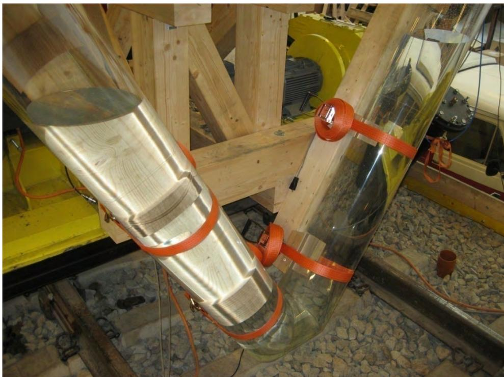
Abbildung 6.71: Plexiglastilger mit eingestellter Stromfadenlänge  $2H$  (Detailansicht)
