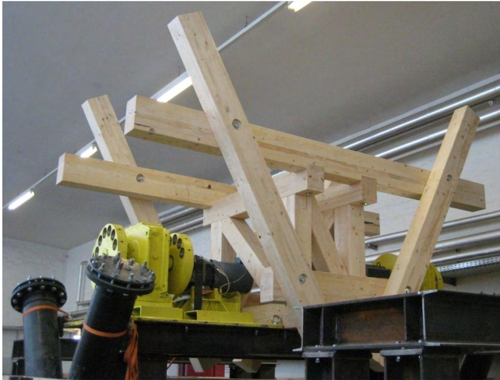
Abbildung 6.61: Holzkonstruktion zur Montage der Flüssigkeitsschwingungstilger der Versuchsreihe 2, Schrägansicht
