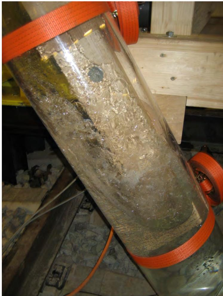
Abbildung 6.112: Momentaufnahme der Flüssigkeitsbewegung beim größeren Luftvolumen
