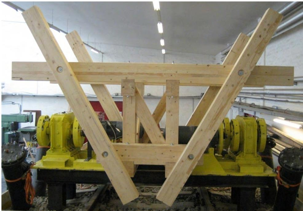
Abbildung 6.62: Holzkonstruktion zur Montage der Flüssigkeitsschwingungstilger der Versuchsreihe 2, Frontalansicht
