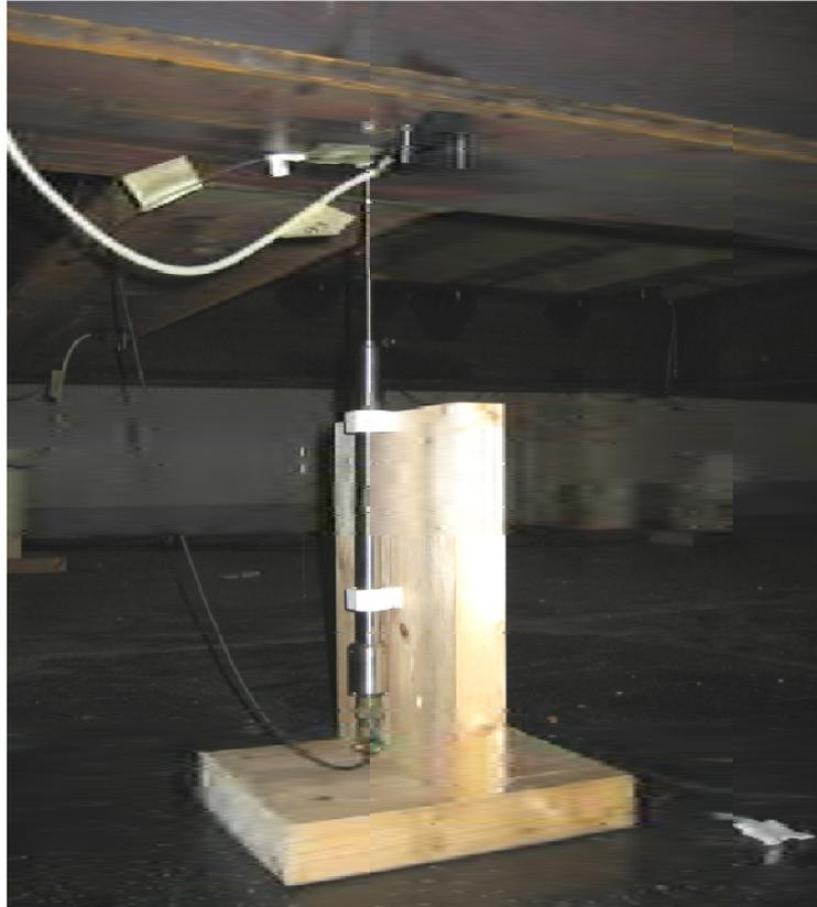
Abbildung 3.75: Wegaufnehmer, Beschleunigungsaufnehmer und Dehnmessstreifen in Brückenmitte
