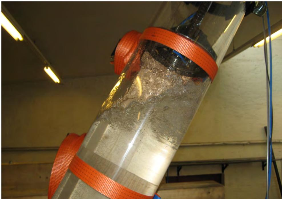
Abbildung 6.110: Momentaufnahme 1 der Flüssigkeitsbewegung beim kleineren Luftvolumen
