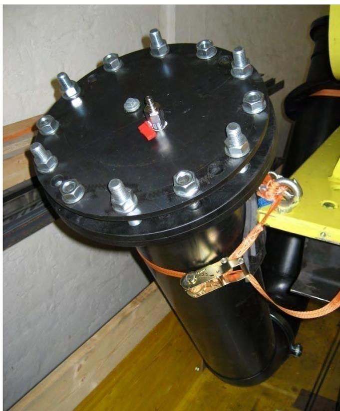
Abbildung 6.3: druckdichter Abschluss der Rohrenden mit Ventil zur Druckaufbringung
