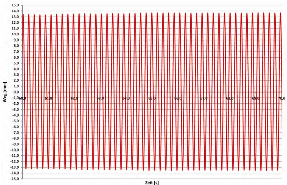
Abbildung 6.7: Verformungen in Brückenmitte im Resonanzfall mit einem aktiven Tilger
