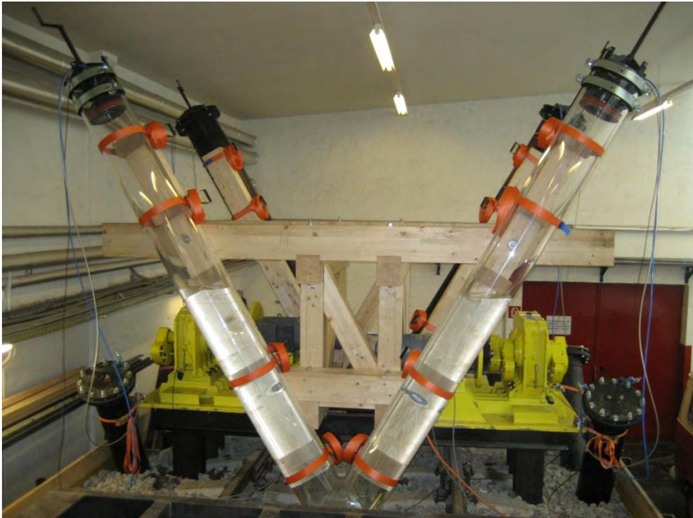
Abbildung 6.72: Plexiglastilger mit eingestellter Stromfadenlänge  $2H$  und montierten und luftdicht abgeschlossenen Rohrabschlüssen
