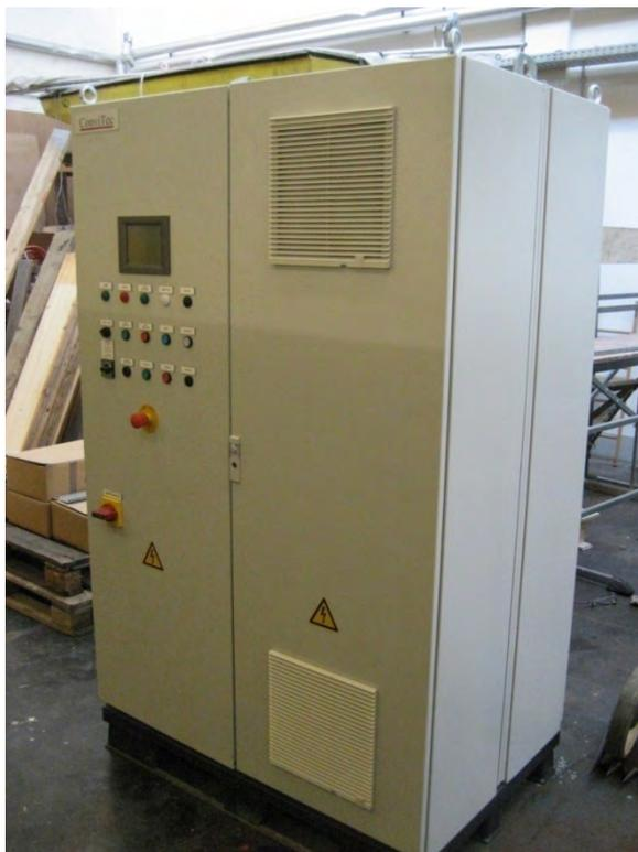
Abbildung 3.67: Schaltschrank zur Steuerung der Unwuchterreger
