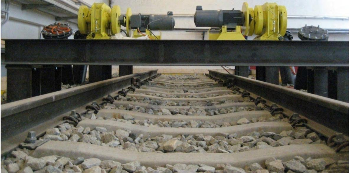
Abbildung 3.41: Versuchsbrücke mit Gleisoberbau (Schotter, Schwellen und Schienen)
