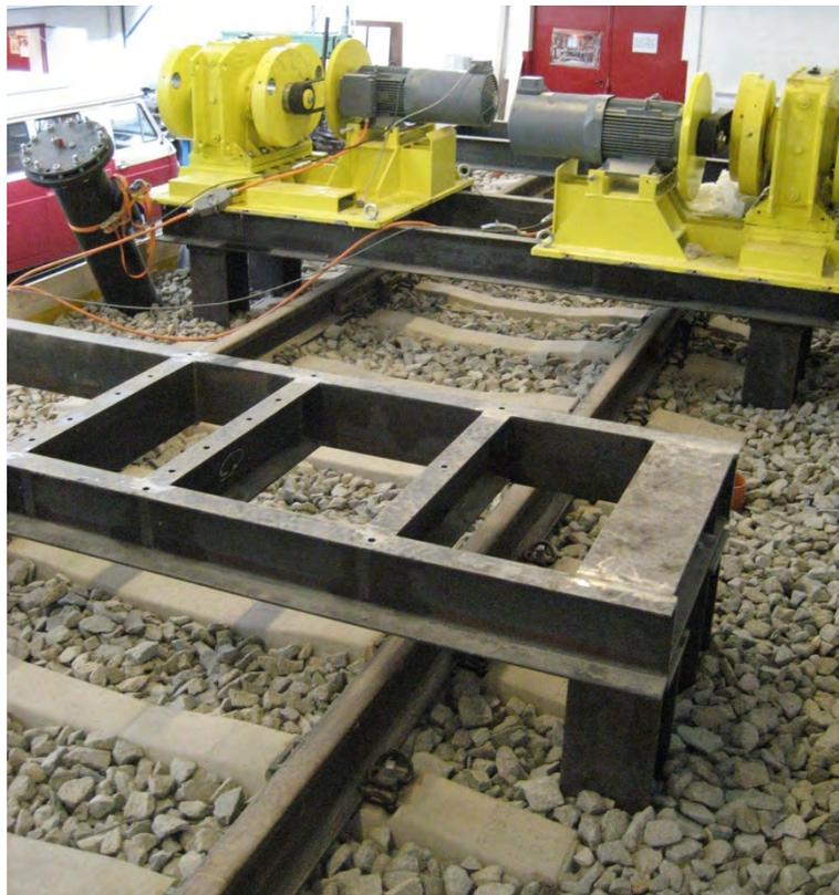
Abbildung 3.42: Versuchsbrücke mit Gleisoberbau (Schotter, Schwellen und Schienen)
