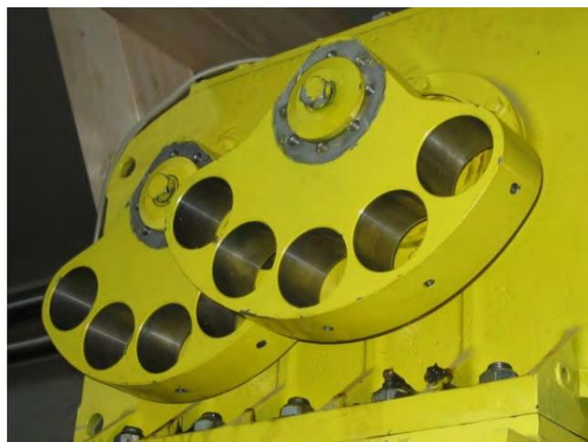
Abbildung 6.78: Unwuchterreger mit montierten Drittelsegmenten, alle Unbalancen ausgebaut
