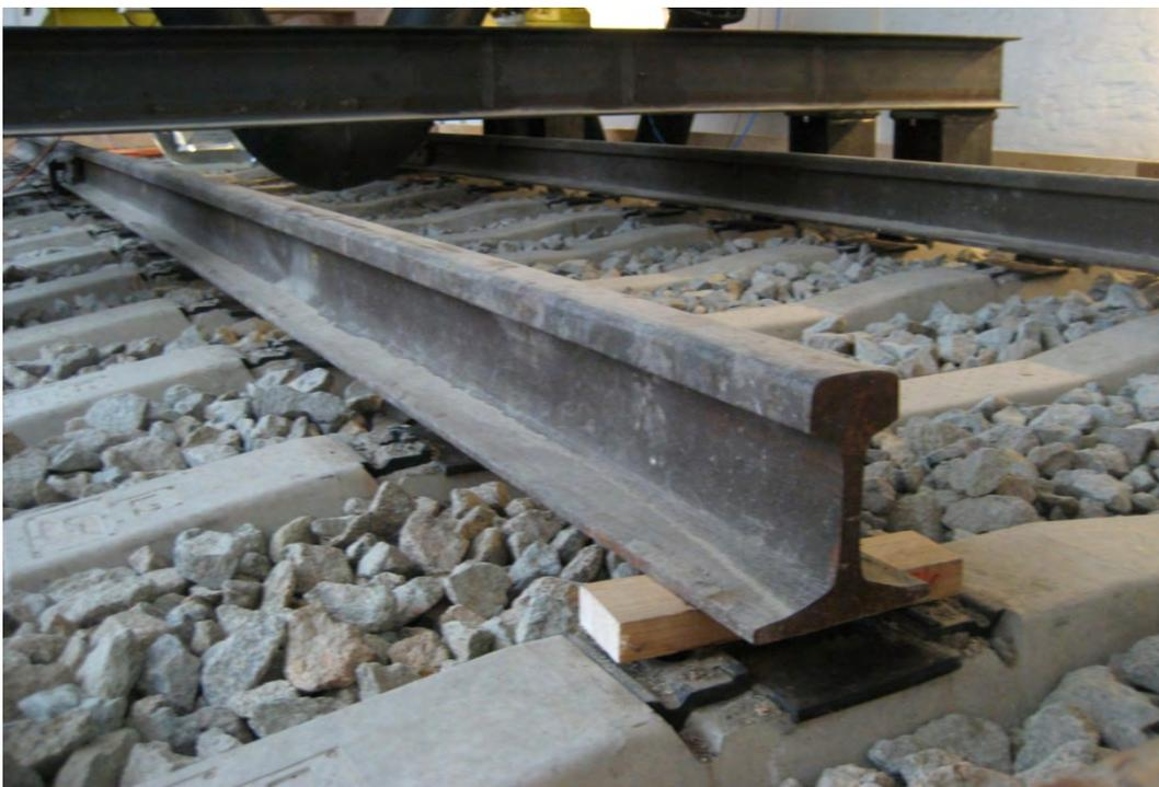
Abbildung 3.54: Schotteroberbau mit von den Schwellen losgelösten und Schienen
