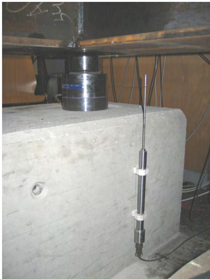
Abbildung 3.31: Kraftmessdosen zur Messung des Brückeneigengewichts
