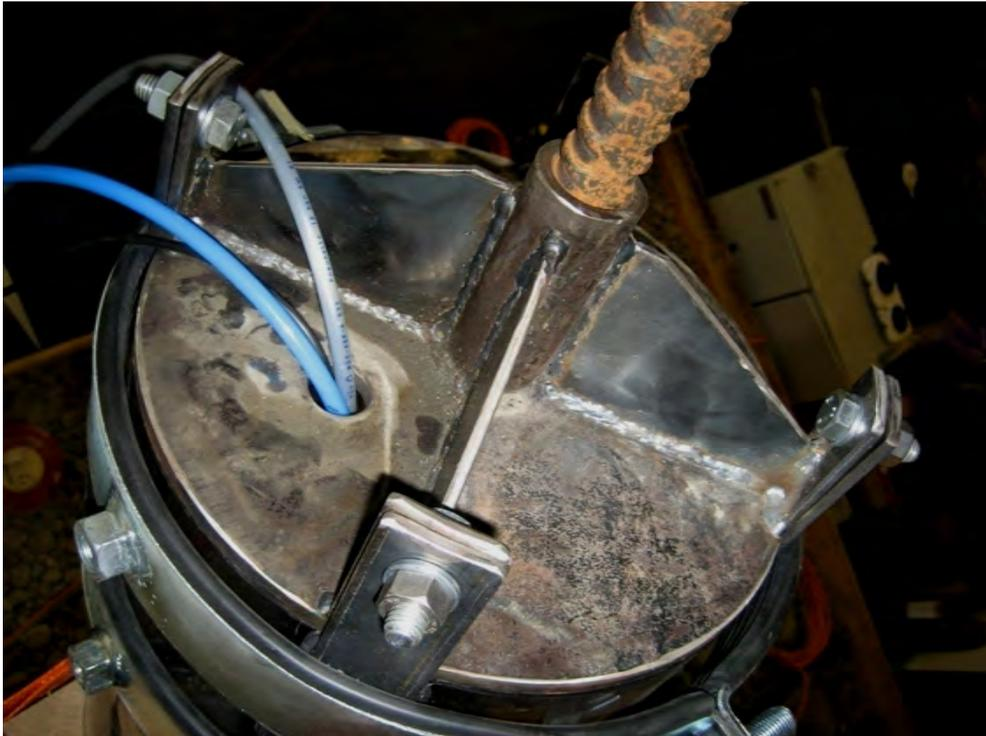
Abbildung 6.69: Befestigungsdeckel sowie Verstellmöglichkeit der Kolbenkonstruktion mit Darstellung der Gewindestange zum Höhenverstellen des Kolbens, den aufgeklebten Stahllaschen samt Rohrschellenverstärkung sowie den Versorgungsleitungen für den Luftdruck der Druckdichtungen (blau) sowie der Rohre (grau) und Datenkabel des Drucksensors (schwarz)
