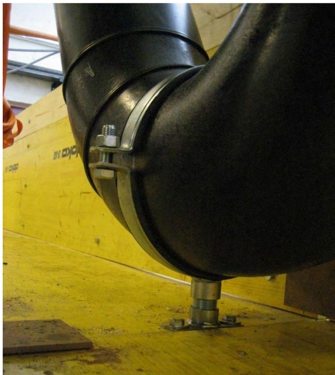
Abbildung 6.2: Kraftschlüssiger Verbund der Tilger mit der Versuchsbrücke realisiert mit Rohrschellen
