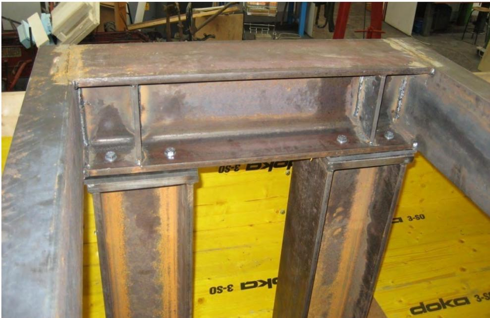
Abbildung 3.12: Anschluss der Unwuchterregerahmen
