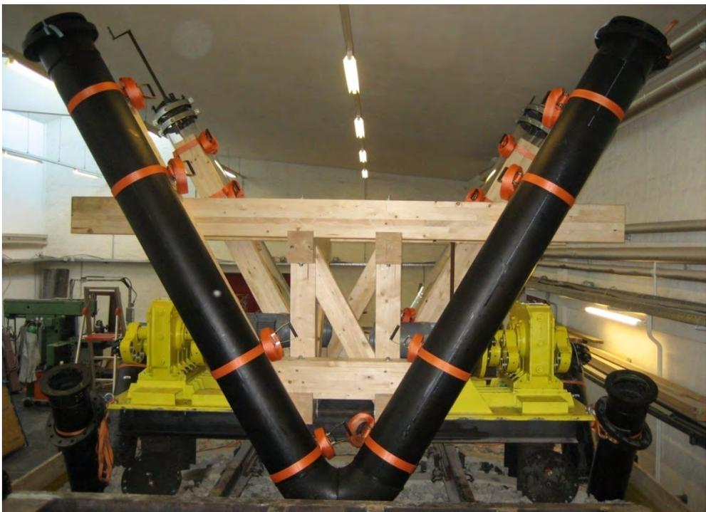
Abbildung 6.64: auf dem Brückentragwerk mittels Holzkonstruktion befestigter PE-HD Tilger
