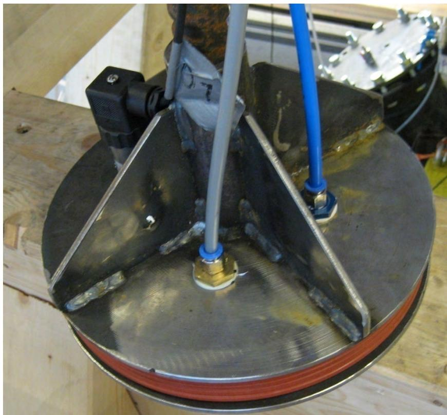
Abbildung 6.68: Draufsicht der Kolbenkonstruktion mit der Zuluftleitung für die Dichtung (blau) sowie für den Rohrüberdruck (grau) und Drucksensor
