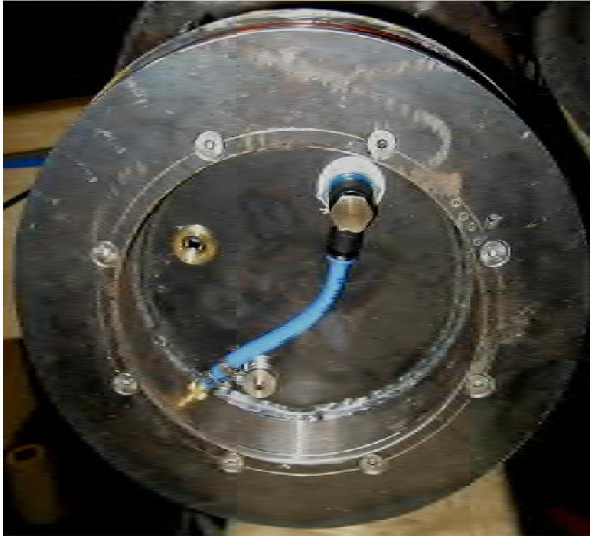
Abbildung 6.67: Untersicht der Kolbenkonstruktion mit dem Anschluss für die Druckdichtungen (blaue Druckluftleitung), dem Einlassventil für den Rohrüberdruck (goldenes Ventil) und dem Drucksensor (silbernes Ventil)
