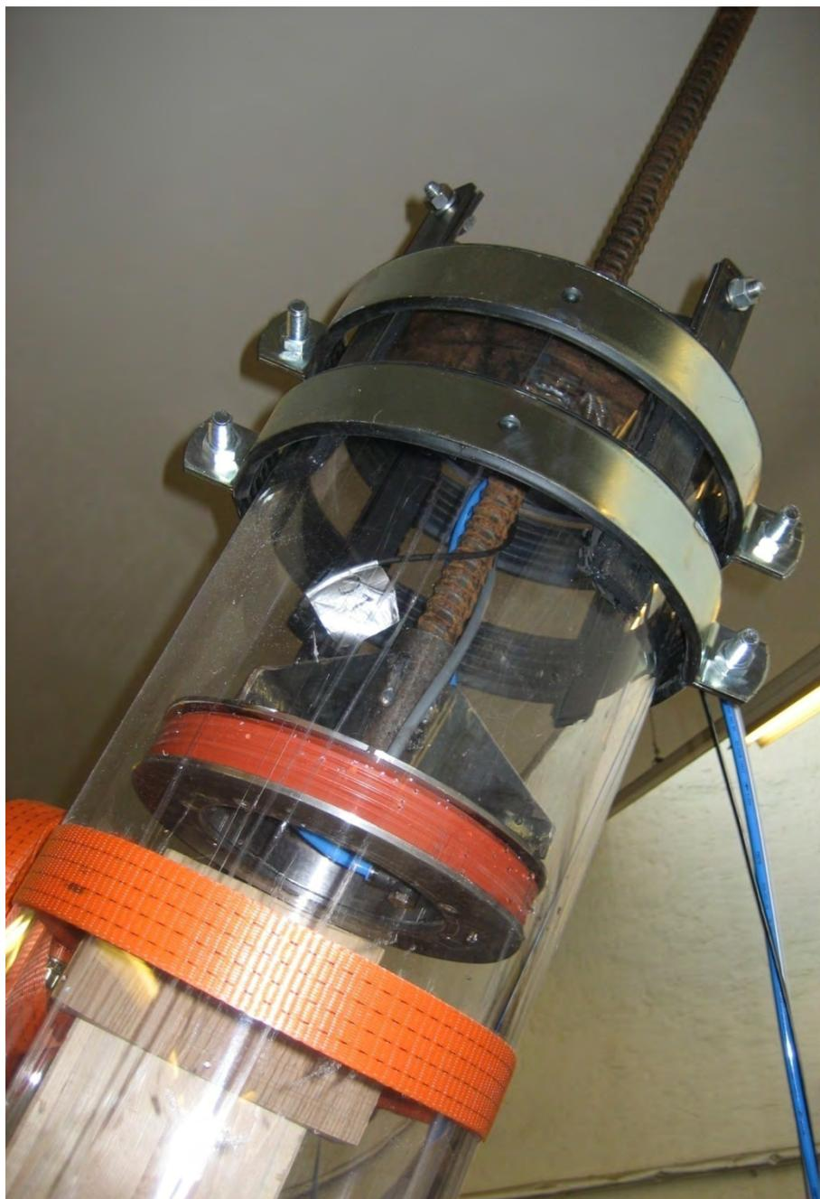
Abbildung 6.66: Abschlusskolben der Plexiglastilger mit Darstellung der aufblasbaren Dichtung, aufgeklebten Stahllaschen mit Rohrschellenverstärkung und Gewindestange
