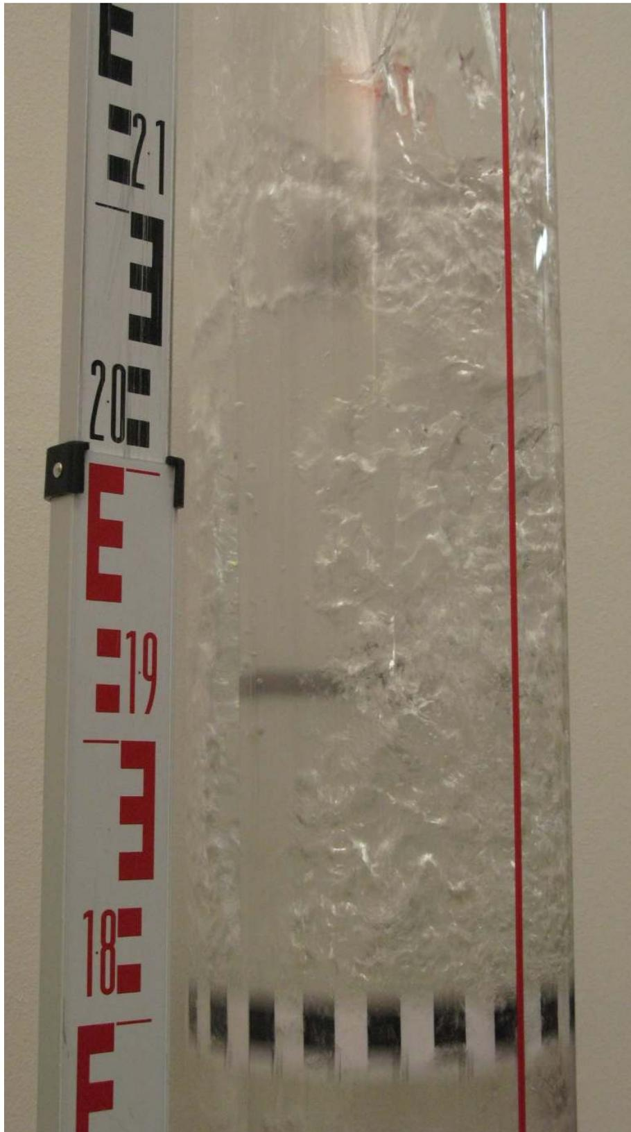
Abb. 7.12: Eintauchvorgang des Meißelmodells in die Flüssigkeit mit erheblicher Turbulenzbildung
