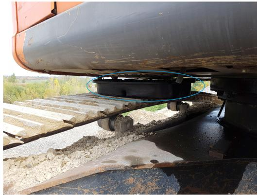
**Abb. 3.28:** Wanne zum Auffangen des austretenden Öls [Foto: Bisenberger]
