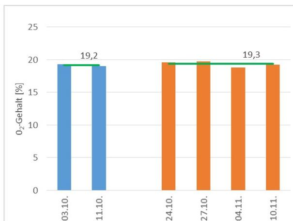
Abb. 5.30: O<sub>2</sub>-Messergebnisse bei 1500 min<sup>-1</sup> – Radlader Zwettl
