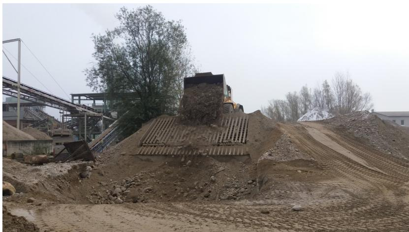
Abb. 3.12: Radlader bei der Beschickung der Siebanlage [Foto: Urban]
