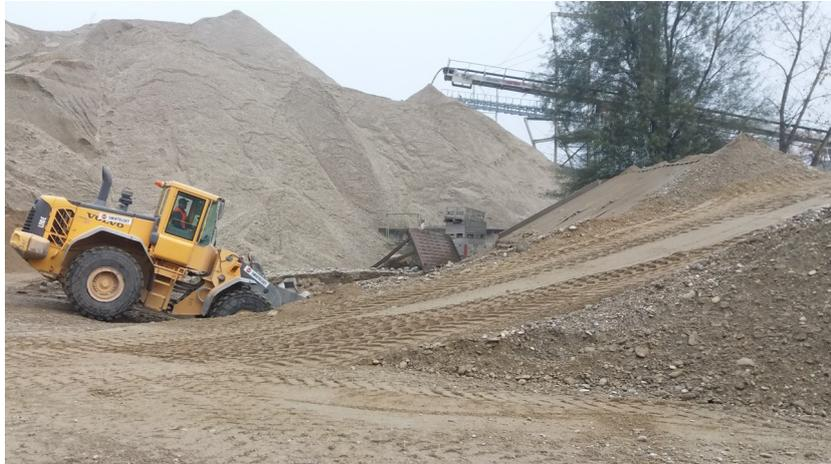
**Abb. 3.13:** Radlader fährt zur Beladung des über den Rechen gerutschten Gesteinsgemisches in die Mulde [Foto: Urban]
