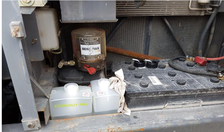
**Abb. 2.25:** Situierung der Wasserbehälter des Kits [Foto: Bisenberger]
