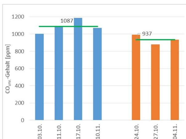
Abb. 5.8: CO<sub>unv</sub>-Messergebnisse bei 800 min<sup>-1</sup> – Raupenbagger
