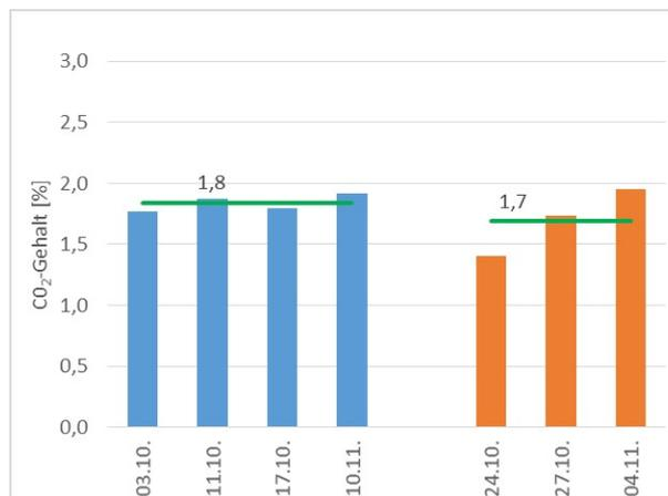
**Abb. 5.2:** CO<sub>2</sub>-Messergebnisse bei 800 min<sup>-1</sup> – Raupenbagger
