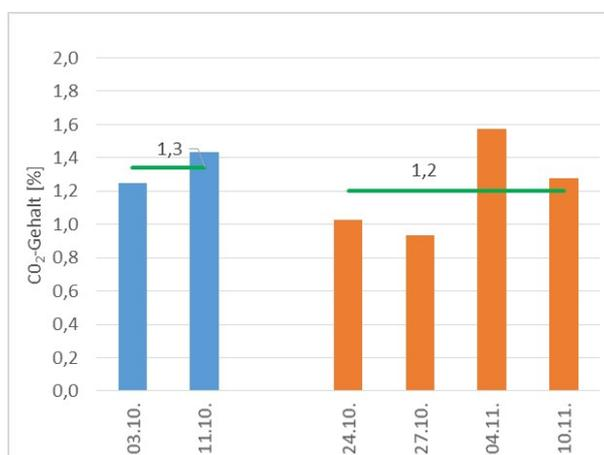
**Abb. 5.27:** CO<sub>2</sub>-Messergebnisse bei 1500 min<sup>-1</sup> – Radlader Zwettl
