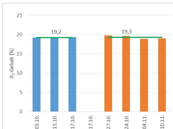
Abb. 5.19: O<sub>2</sub>-Messergebnisse bei 2240 min<sup>-1</sup> – Radlader Traismauer
