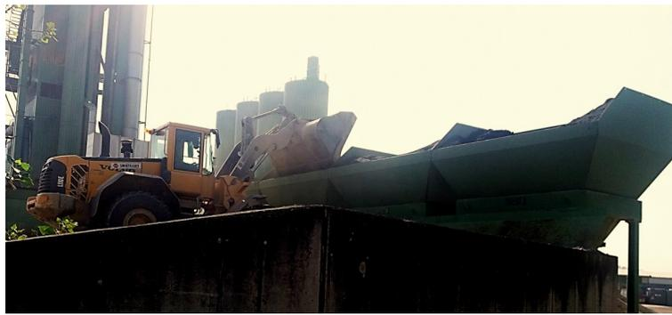
Abb. 3.11: Radlader beim Befüllen eines Doseurs [Foto: Urban]
