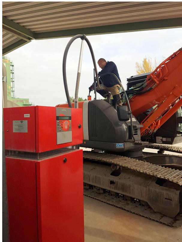
**Abb. 3.10:** Tankvorgang in Traismauer beim Hydraulikraupenbagger [Foto: Bisenberger]
