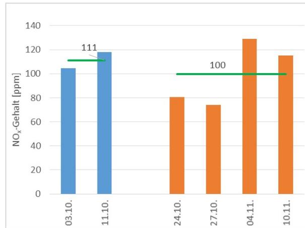
**Abb. 5.36:** NO<sub>x</sub>-Messergebnisse bei 1500 min<sup>-1</sup> – Radlader Zwettl
