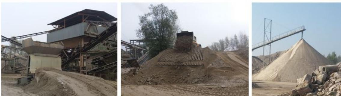
**Abb. 3.4:** Doseure für Siebanlage (li.), Hauptbeschickungsanlage (mi.), Zwischenlager (re.)
