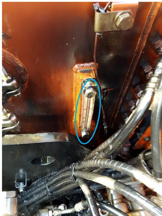
**Abb. 3.29:** Undichtiges Schauglas beim Raupenbagger [Foto: Bisenberger]
