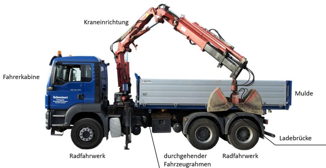
**Abb. 2.8:** Aufbau eines Solofahrzeugs [Quelle: Schweinert TRANSPORTE GmbH]
