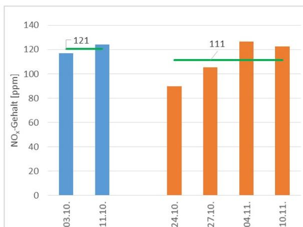
Abb. 5.35: NO<sub>x</sub>-Messergebnisse bei 800 min<sup>-1</sup> – Radlader Zwettl
