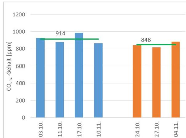
**Abb. 5.10:** CO<sub>unv</sub>-Messergebnisse bei 1700 min<sup>-1</sup> – Raupenbagger
