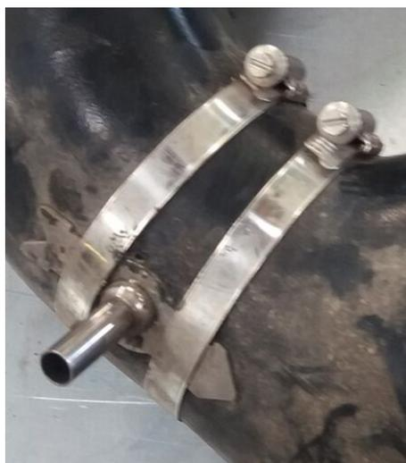
Abb. 2.23: Fixierung des Ansaugrohrs [Foto: Urban]
