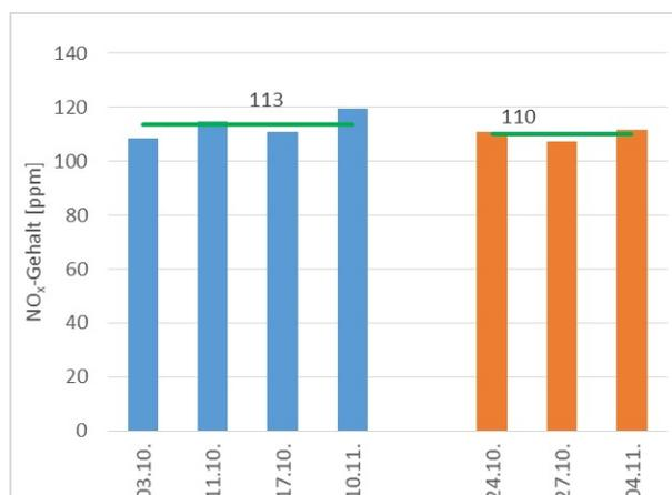
**Abb. 5.13:**  $\text{NO}_x$ -Messergebnisse bei  $1700 \text{ min}^{-1}$  – Raupenbagger
