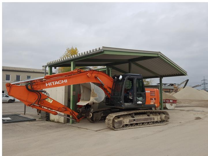
**Abb. 3.9:** Positionskonfiguration des Stiels beim Tankvorgang [Foto: Bisenberger]
