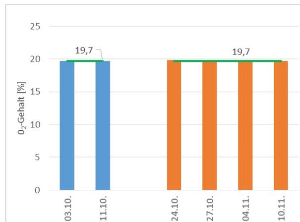
**Abb. 5.29:** O<sub>2</sub>-Messergebnisse bei 800 min<sup>-1</sup> – Radlader Zwettl
