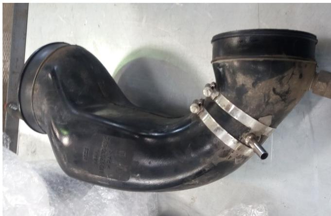
**Abb. 2.20:** Version 1 – Luftansaugstrang mit Düse beim Lastkraftwagen MAN [Foto: Urban]
