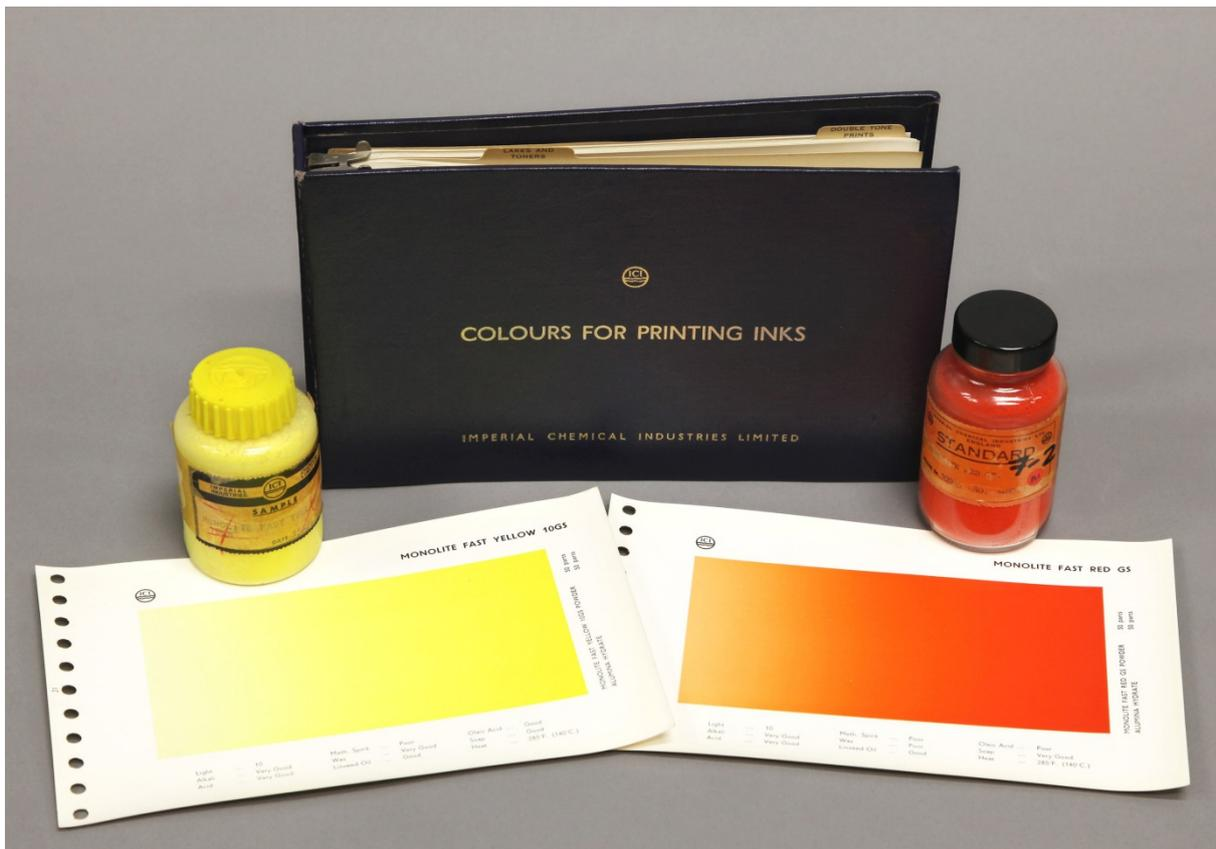
Abb. 30: Pigmentpulver-Referenzmaterialien aus der technologischen Sammlung des INTK und Farbkarte der Firma ICI mit Pigmentaustreichen variierender Farbtiefe.
