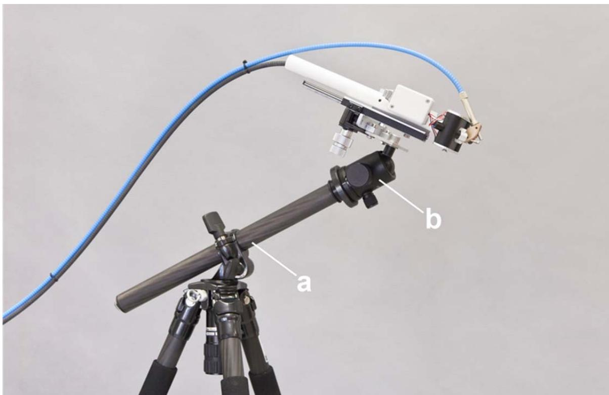
Abb. 11: Multifunktionaler Messkopf mit Glasfaseroptiken montiert auf einem Dreibeinstativ mit schwenkbarer Mittelsäule (a) und Kugelkopf (b). Mit dieser Vorrichtung sind Messungen in beliebiger Raumrichtung möglich.
