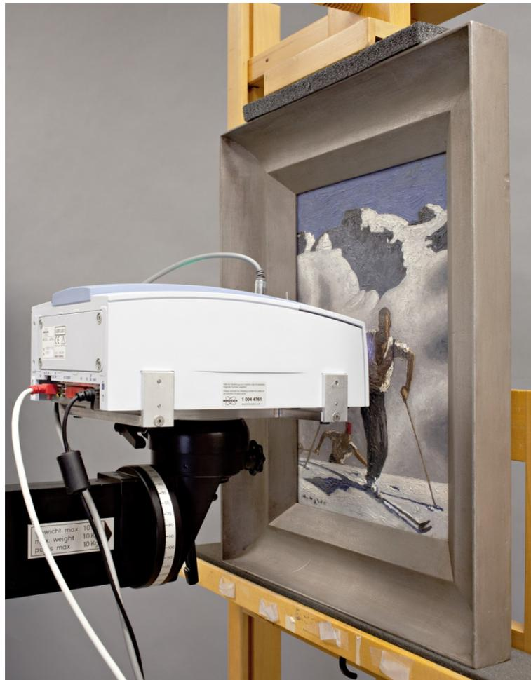
Abb. 65: r-FTIR-Untersuchung eines Ölgemäldes von Alfons Walde auf einer Staffelei. Das Messinstrument ist auf einem robusten Studiostativ montiert. Der Zierrahmen verhindert Messungen im Randbereich.
