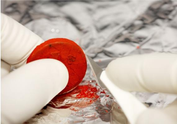
Abb. 18: Probenahme mittels Skalpell.
