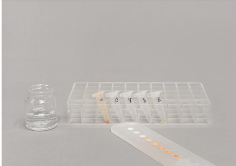
Abb. 23: Filterpapierscheiben mit Pigmentauftrag in Plexiglashalterung.
