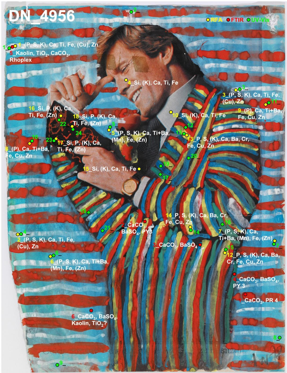
Abb. 74: Objekt DN4956, das dem österreichischen Künstler Franz West (1947-2012) zugeschrieben wird. Eingezeichnet sind die Messpunkte der RFA (gelb, detektierte Elemente angeführt), r-FTIR und FTIR-Mikroskopie (rot, nachgewiesene Verbindungen angeführt) sowie r-UV/Vis/NIR-Analyse (grün).
