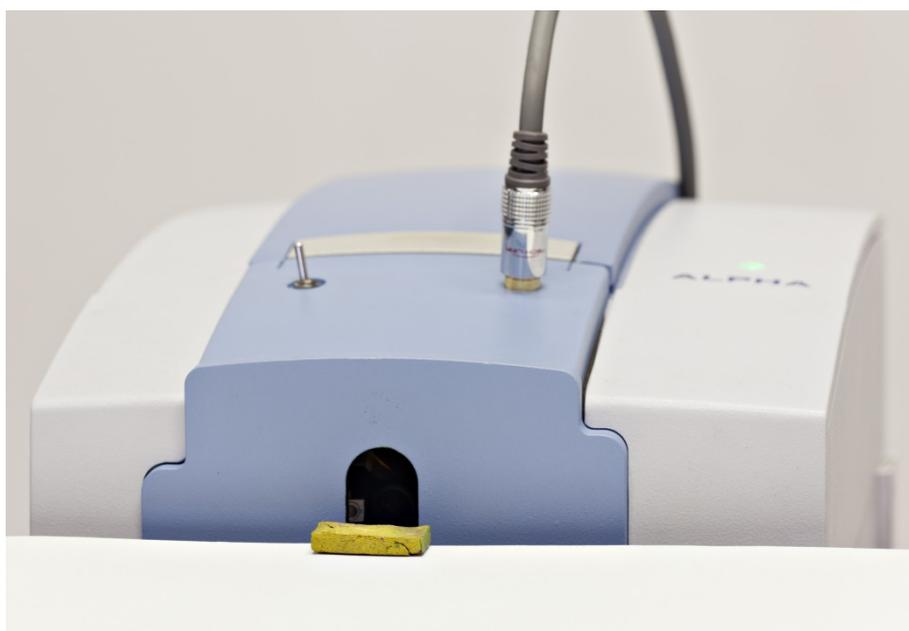
Abb.29: Zerstörungsfreie r-FTIR-Analyse eines originalen Farbknopfes von Moritz M. Daffinger mittels Bruker ALPHA mit Modul für externe Reflexion.
