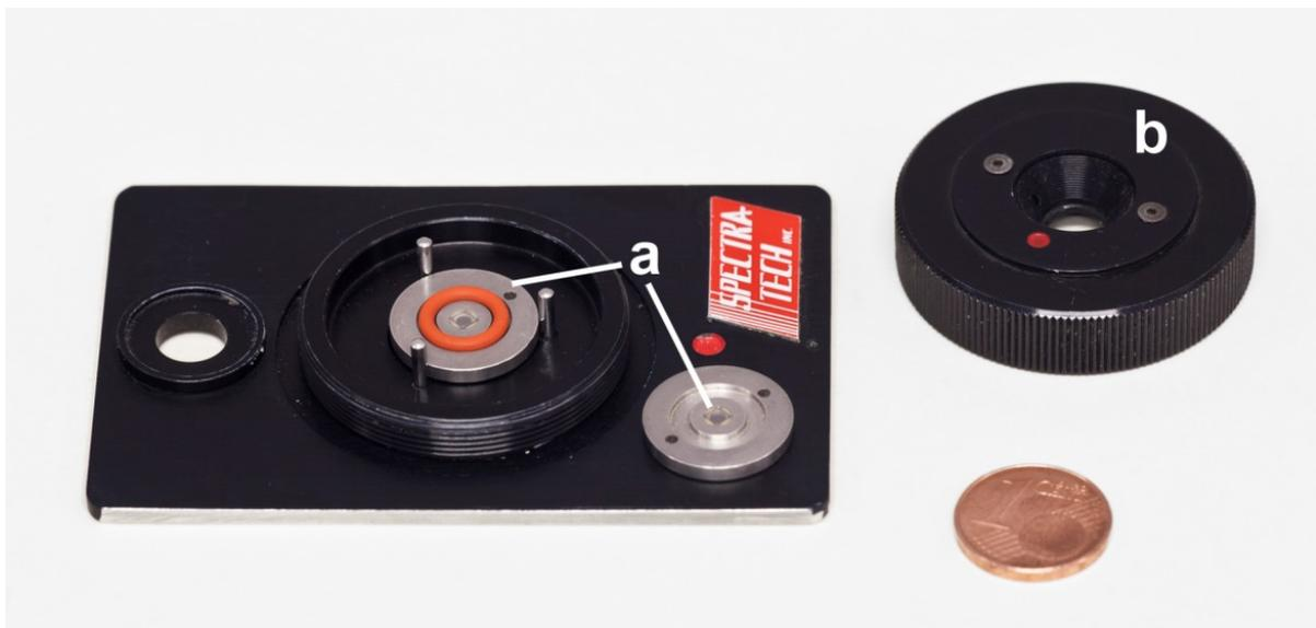
Abb.15: Diamantzelle zum Flachpressen kleiner Proben für die FTIR-Mikroskopie. Die Probe wird zwischen den beiden Diamantfenstern (a) durch Aufsetzen des Schraubdeckels (b) gepresst, um eine ausreichende Transparenz zu erreichen. Zum Größenvergleich ist eine 1 Cent Münze beigelegt.
