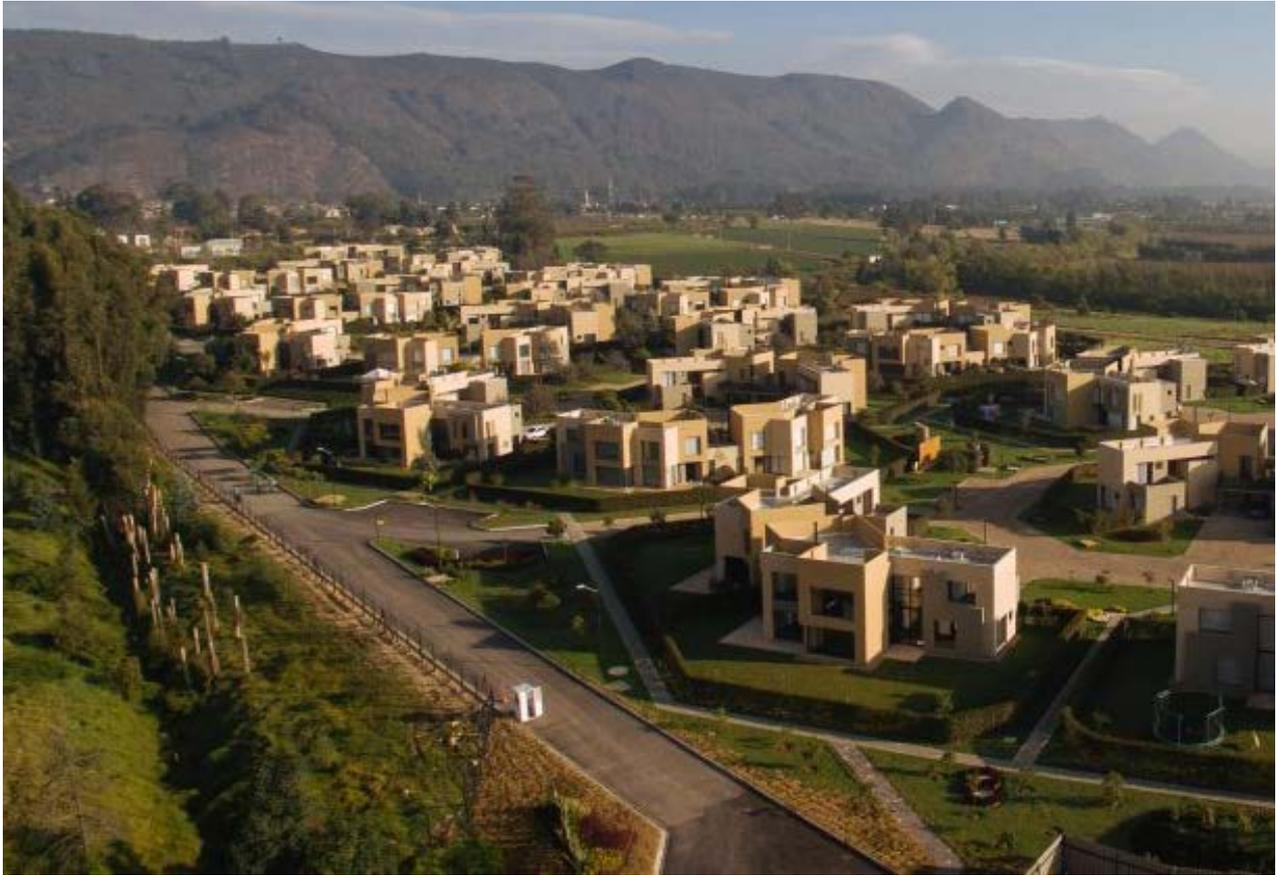
Abb. 44: Cota Gartenstadt in Cundinamarca, Konstruktion aus gepressten Lehmblöcken welche vor Ort manuell hergestellt werden, Tierra Tec
